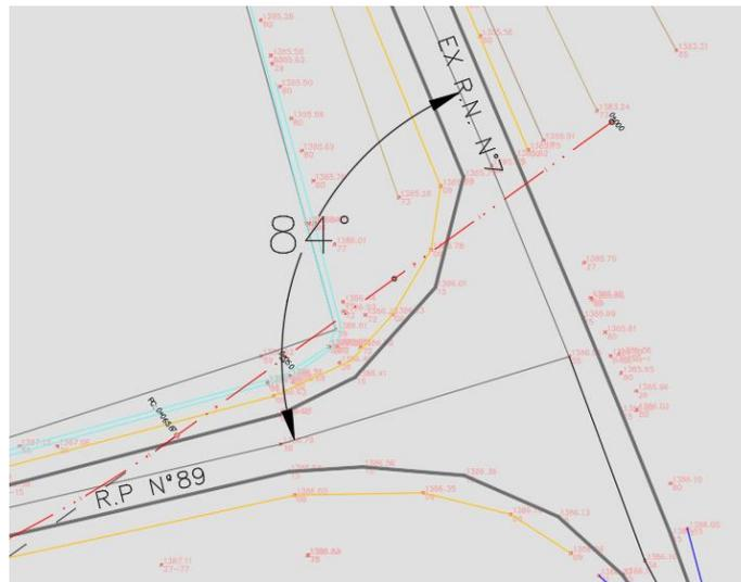
Figura 94: Ángulo entre ejes existentes de las trazas de la ex RN N°7 y la RP N°89. Fuente: elaboración propia.
