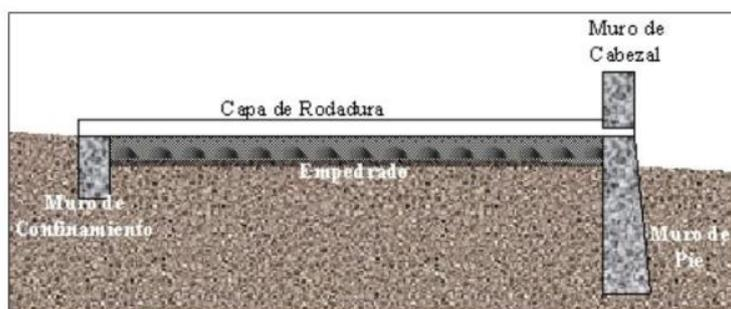
Figura 127: Esquema de composición de un badén. Fuente: Brezhney, G. y Rosario, A. (2012).
