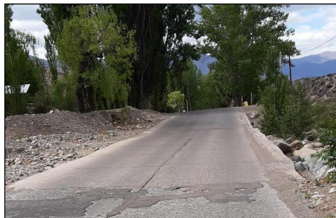
*Figura 26: Pérdida de visibilidad luego del vértice de la curva vertical convexa. Fuente: Elaboración propia.*
