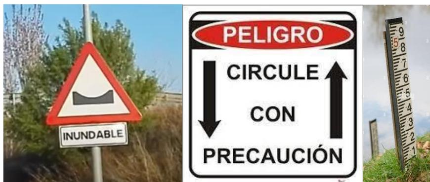
Figura 130: Cartelería vial sugerida a colocar sobre badén existente. Fuente: Google Imágenes.
