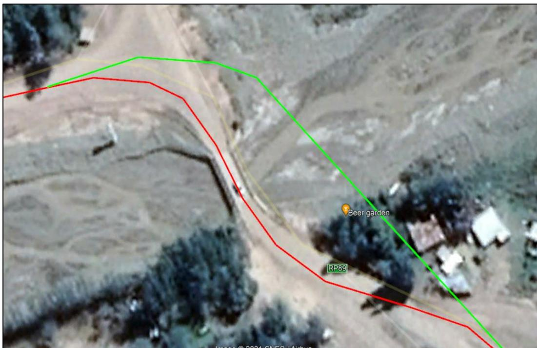
Figura 9: trazado tentativo del nuevo puente a proyectar (en verde), comparado con el eje del puente existente (rojo). Fuente: software Google Earth (octubre, 2021).
