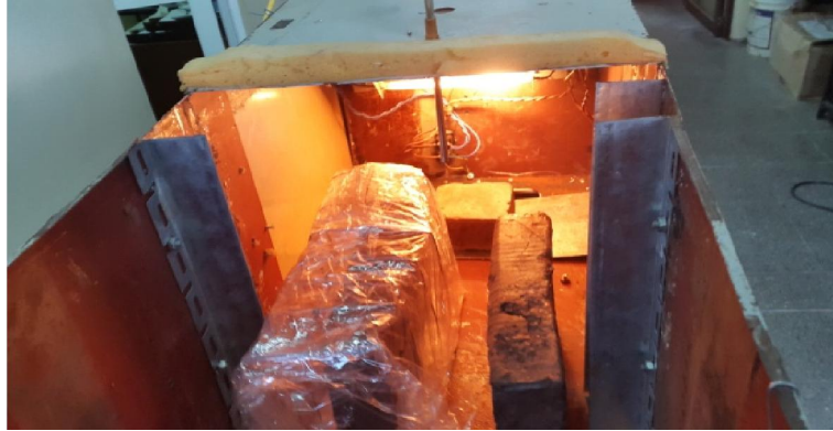
Figura 2. Disposición de los adobes en el túnel de secado Fuente: elaboración propia
