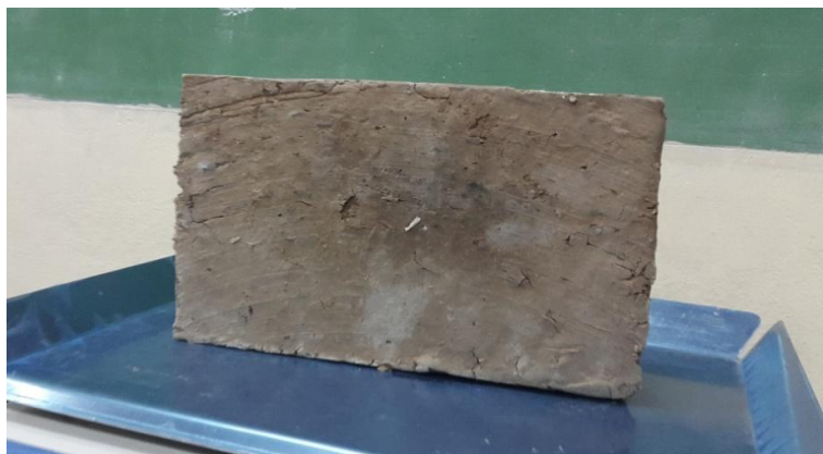
Figura 4. Adobe sin fisuras Fuente: elaboración propia
