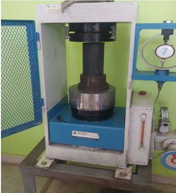
Figura 4: Ensayo de compresión uniaxial
