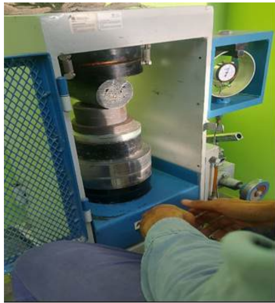
Figura 5: Ensayo de compresión diametral
