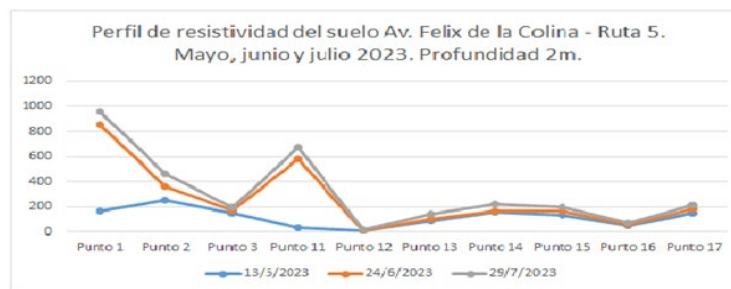
Figura N° 5.c: Perfil de Resistividad obtenidos en Avenida Félix de La Colina y Ruta Provincial N°5. Meses de mayo, junio y julio del 2023. Profundidades de 2m.
