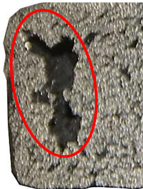
Figura 4.8 - Oclusión de aire en una muestra fabricada sin la implementación de la mesa vibratoria.
