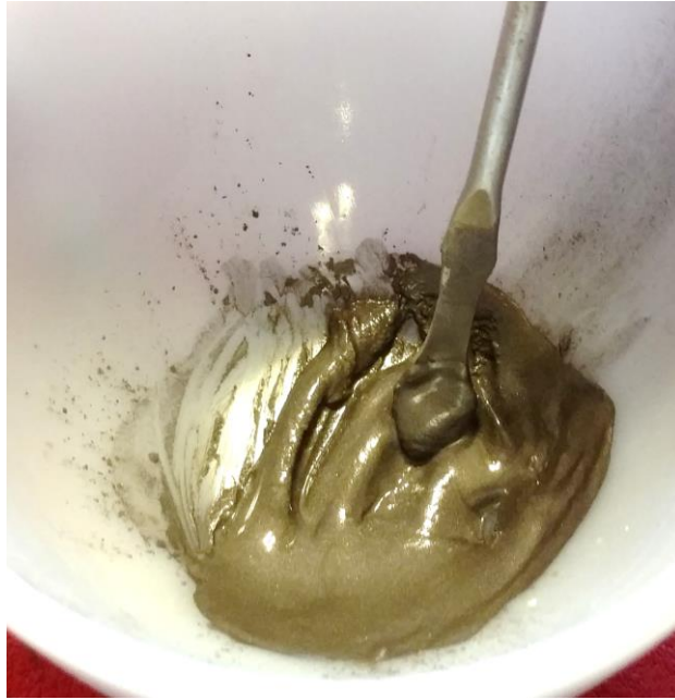
Figura 4.7 - Consistencia del barro previo al colado.
