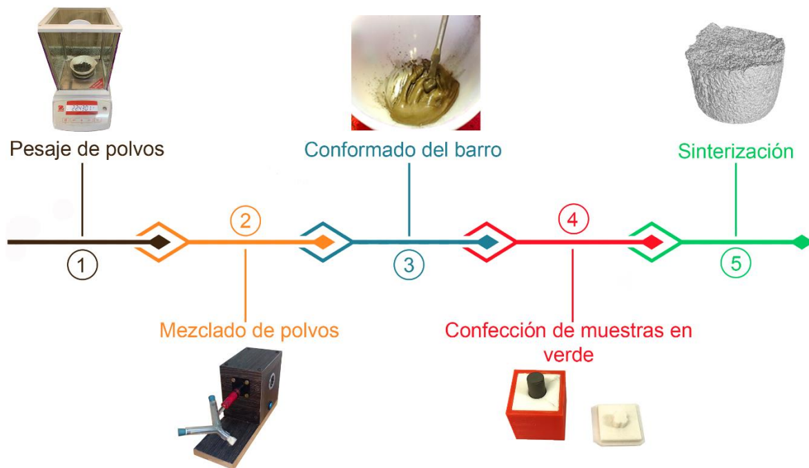
Figura 3.1 - Metodología propuesta para la fabricación de estructuras porosas por Gel-Casting y Sinterización.
