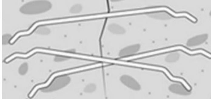
Figura 6.8: Esquema de fibras cosiendo una fisura.
