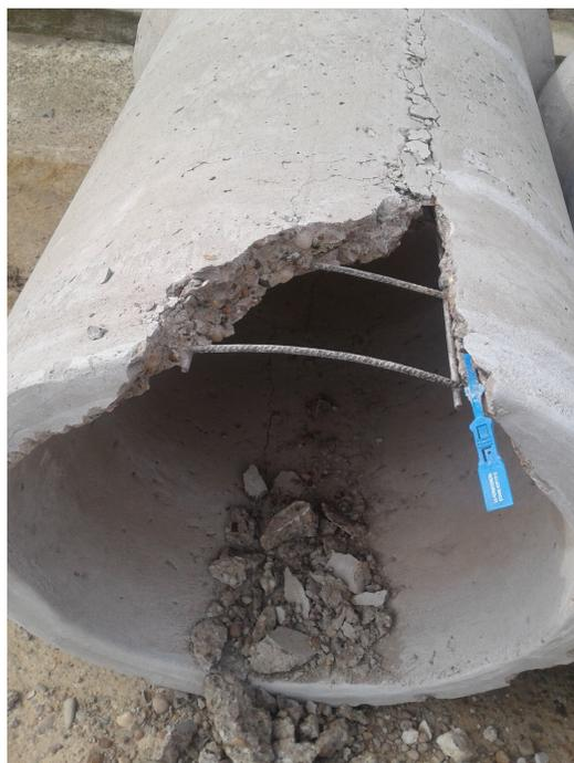
Figura 3.17: Modo de falla a flexión de tubos con armadura de barras.
