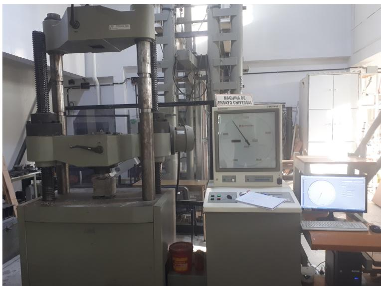
Figura 3.4: Máquina de ensayo universal Shimadzu UH-1000kNC.
