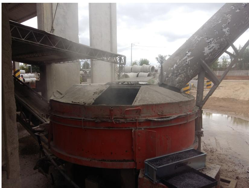
Figura 3.2: Mezcladora de eje vertical.
