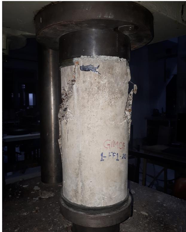
Figura 3.5: Ensayo de compresión uniaxial.
