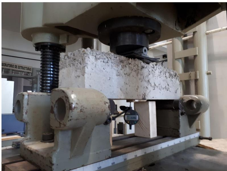
Figura 3.7: Ensayo de viga a flexión con entalla.
