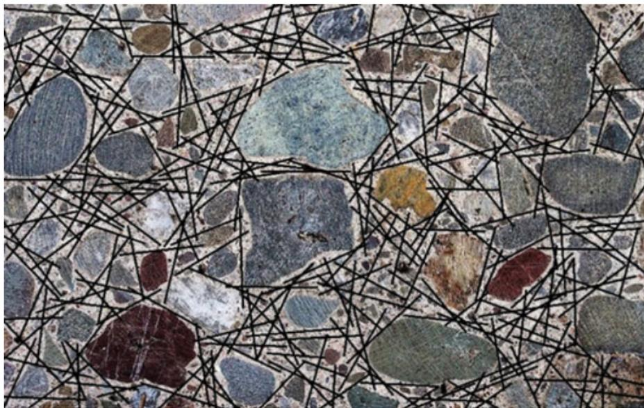
Figura 2.2: Esquema de la distribución de las fibras de acero dentro de la masa de hormigón.
