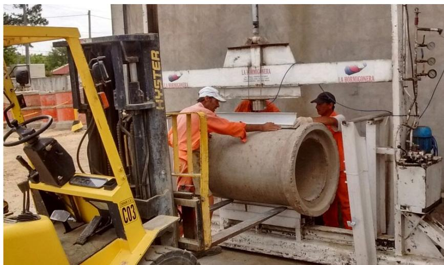
Figura 3.12: Montaje de tubo de HRFA en maquinaria de ensayo.
