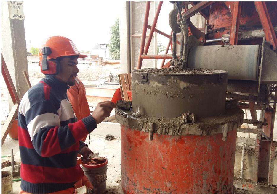
Figura 3.9: Proceso de llenado y vibrado de tubos.
