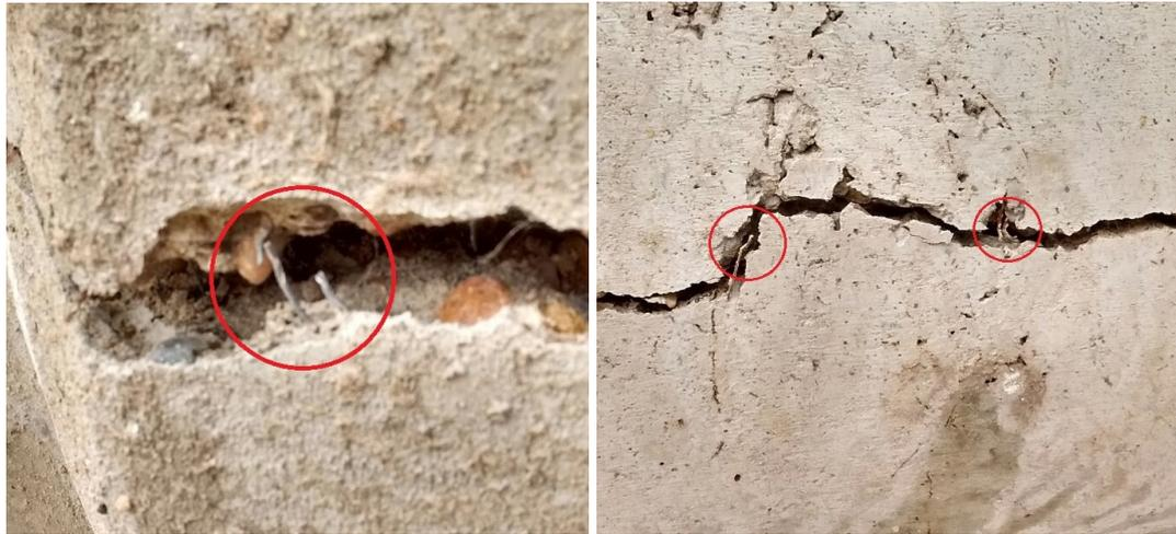
Figura 3.16: Arrancamiento de fibras en tubos de HRFA.
