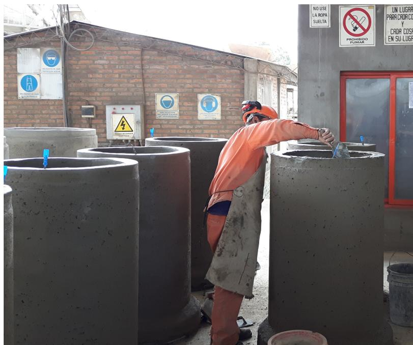
Figura 3.10: Terminación superficial de tubos y acopio bajo ambiente techado.
