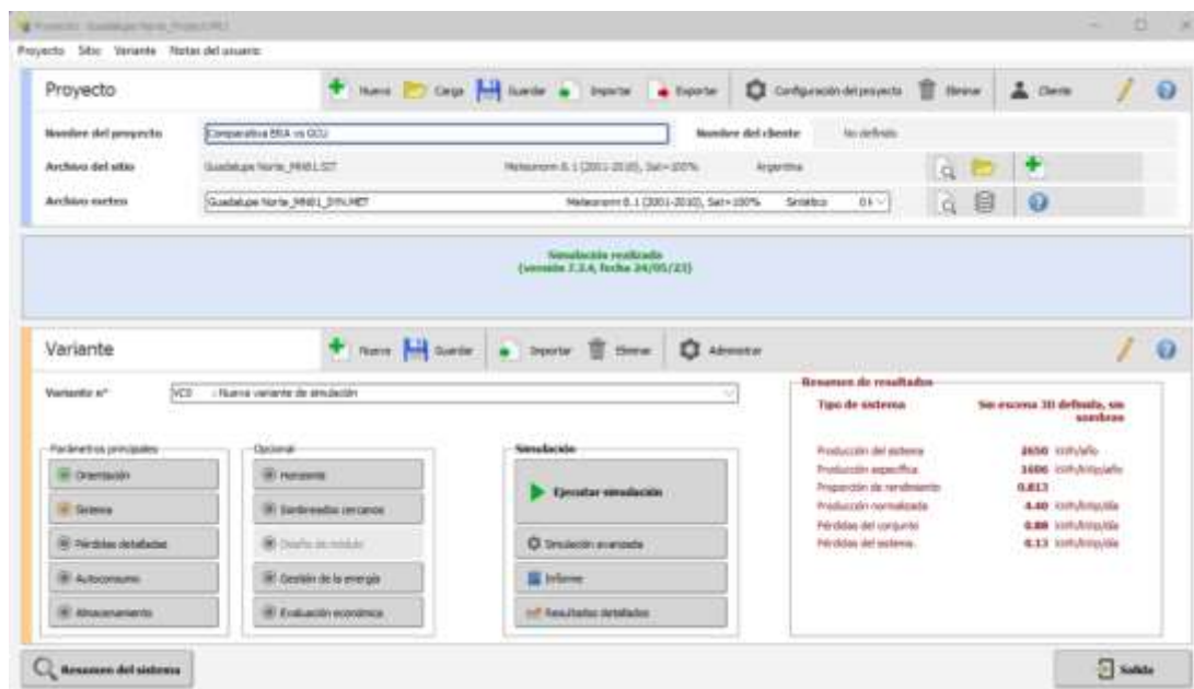
Imagen N° 18: Captura de software PVsyst, interfaz para diseño y simulación de un sistema conectado a la red.
