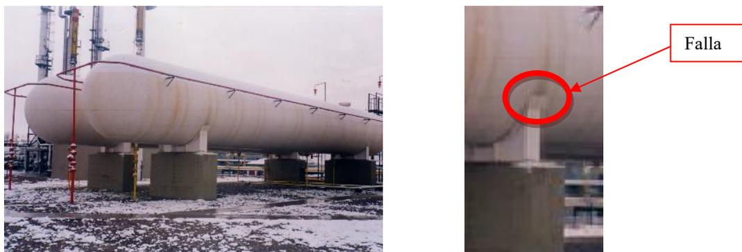
Figura 1: recipiente horizontal soportado en dos cunas. A la derecha zona de falla, tensión circunferencial sub-dimensionada.
