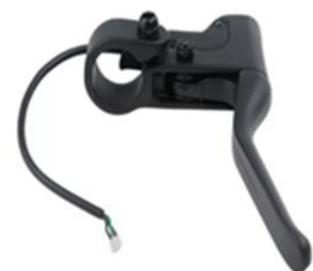
modificarse, de esta manera es posible que, si la palanca es pulsada de forma ligera, en la primera parte de su recorrido solo actúa el freno motor sin activarse el sensor. Una vez apretada por completo la palanca actúa el freno mecánico.
