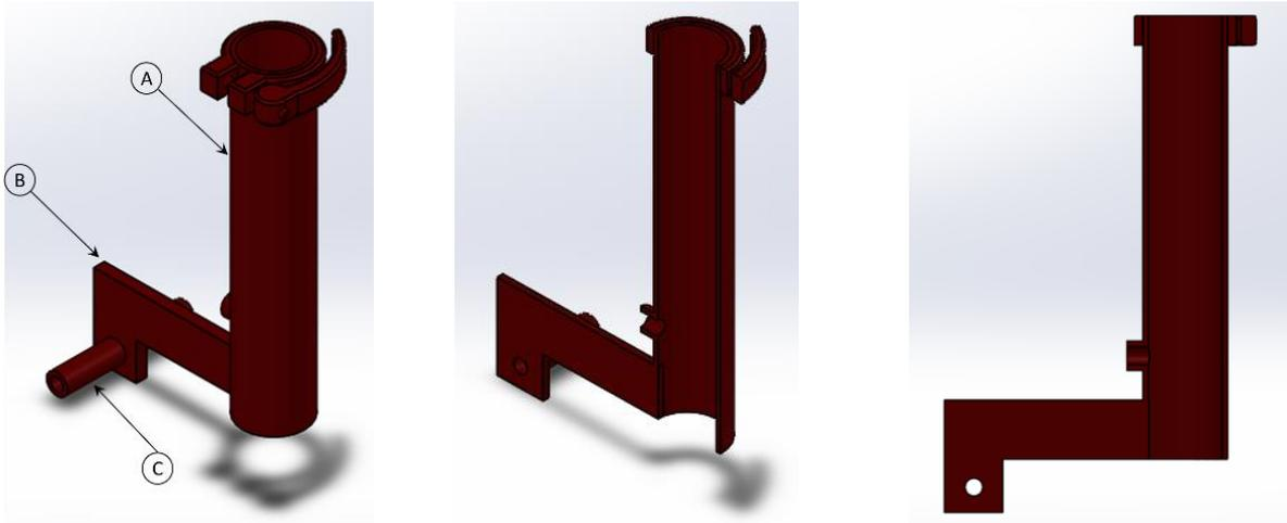
**Imagen 13:** Pieza bisagra y sus componentes.
