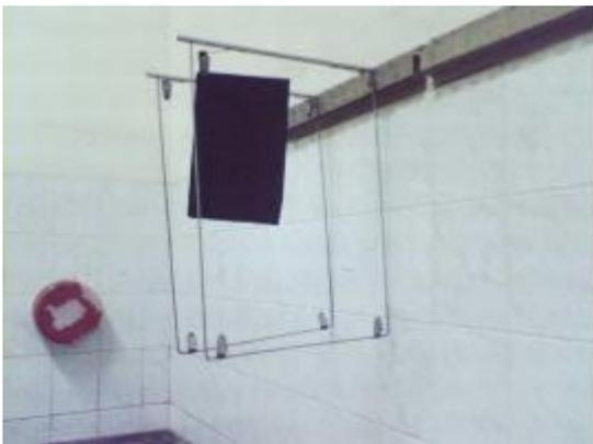
**Ilustración 8** Secado de películas radiográfica
