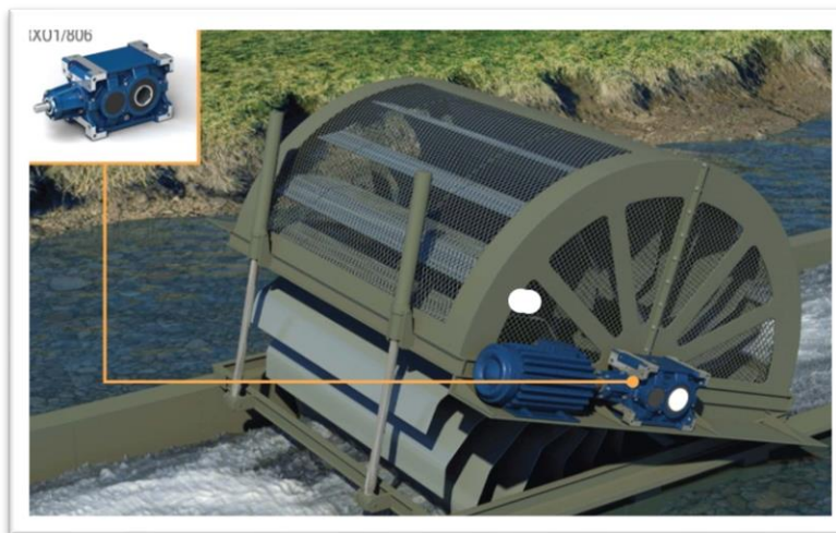
Figura n°36: Turbina hidráulica accionada mediante un motor reductor.
