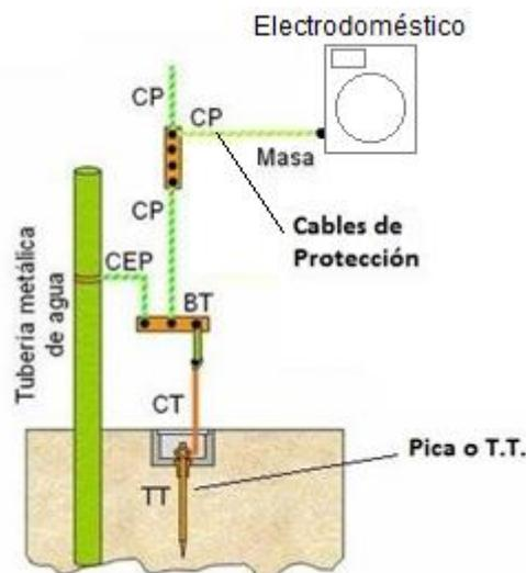
Figura 10. Esquema básico de un sist. de puesta a tierra
