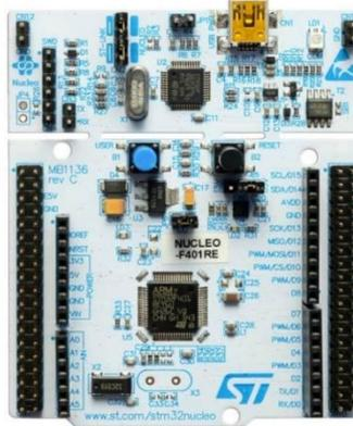
Figura 6: Placa Núcleo 401
