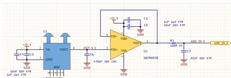
Figura 2: Sensor y adaptación de señal por cada canal
