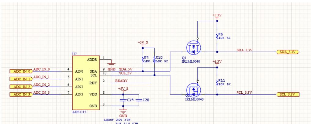
Figura 3: Adaptación de nivel para bus I<sup>2</sup>C
