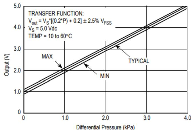
Figura 1: Transferencia de salida
