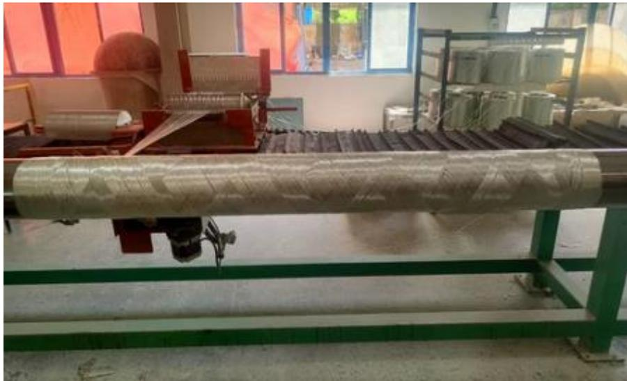
*Imagen: Maquina de bobinado de filamento - 3 Axis. Fuente: Filament Winder
