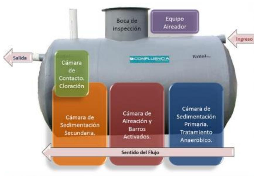
Ilustración 146: Sistemas Compactos para Tratamiento de Efluentes (SiCTE)
