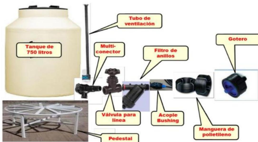
Ilustración 89: Sistema de cloración por goteo (ProAgua)
