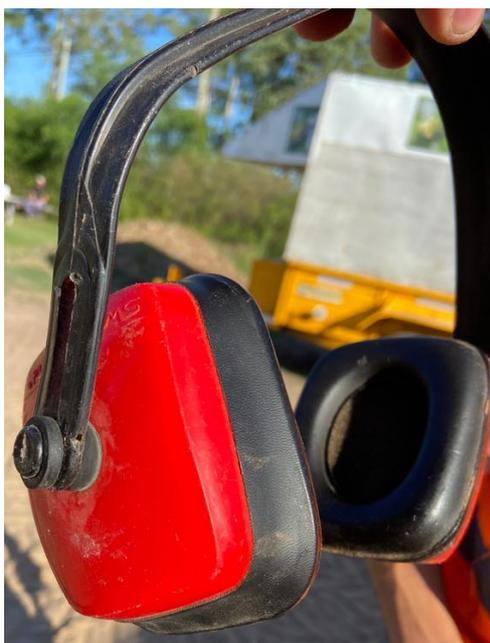
**IMAGEN 17 PROTECCIÓN AUDITIVA QUE UTILIZAN LOS OPERARIOS MARCA: FRAVIDA. ATENUACION DE RUIDO 22 DB.**
