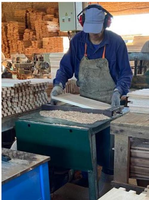
**IMAGEN 10 OPERARIO UTILIZANDO MÁQUINA MACHETADORA**
