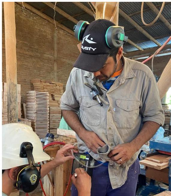
**IMAGEN 21 COLOCACIÓN DE INSTRUMENTO PARA LA MEDICIÓN DE PARTICULADO
