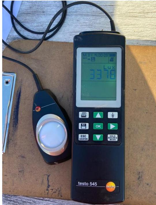
IMAGEN 26 INSTRUMENTO PARA MEDIR PUNTOS DE ILUMINACIÓN: LUXÓMETRO
