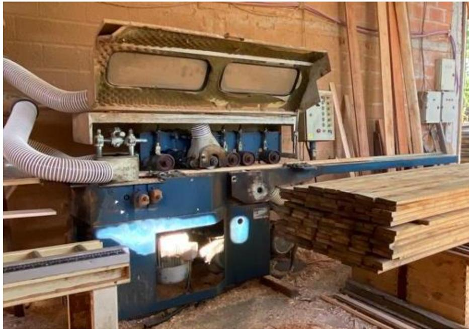
**IMAGEN 8 MÁQUINA MACHIMBRADORA**
