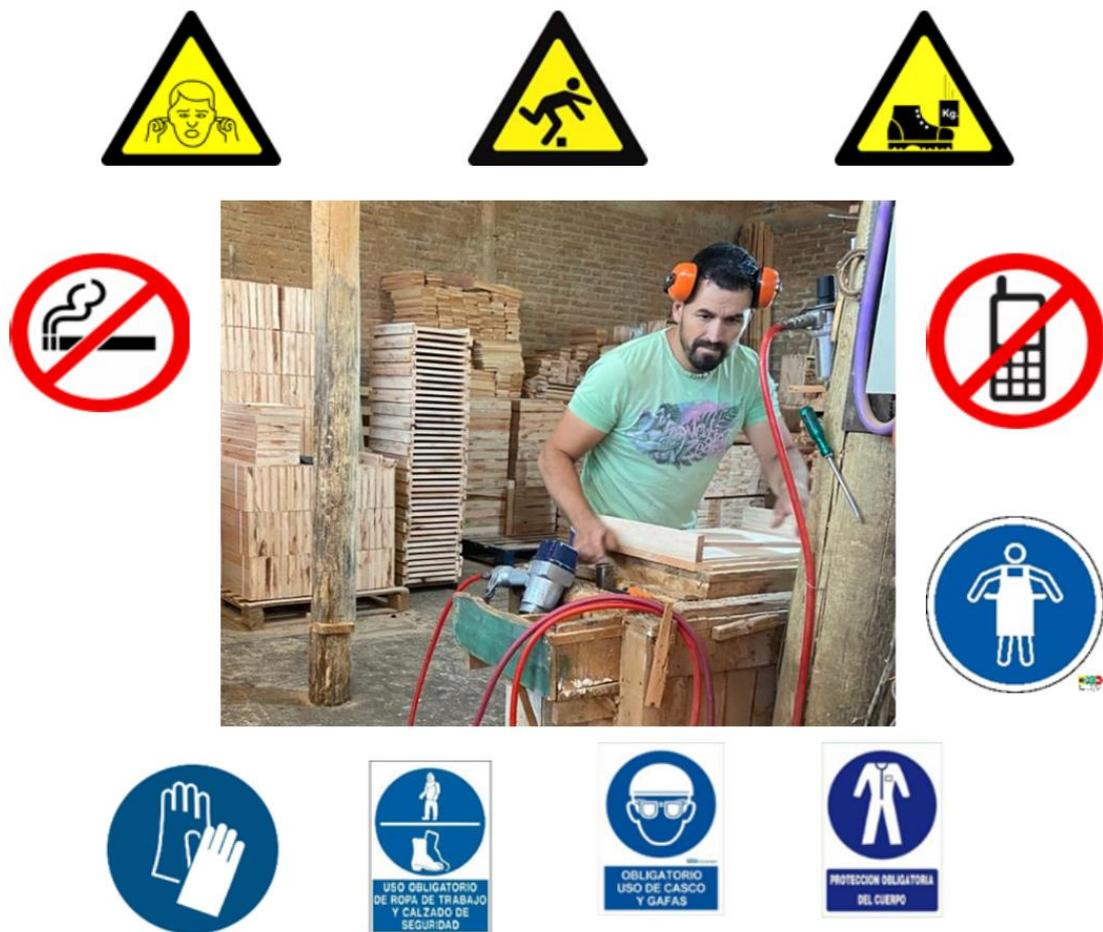
IMAGEN 34 ARMADO DE PIEZAS CON ENGRAPADORA
