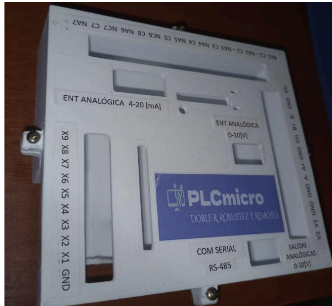
Ilustración 58 - Identificación de entradas y salidas.
