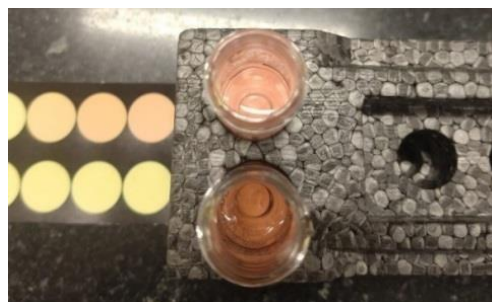
Fig. 4. Lectura de contenido de \text{Cl}_2 en la tarjeta colorimétrica
