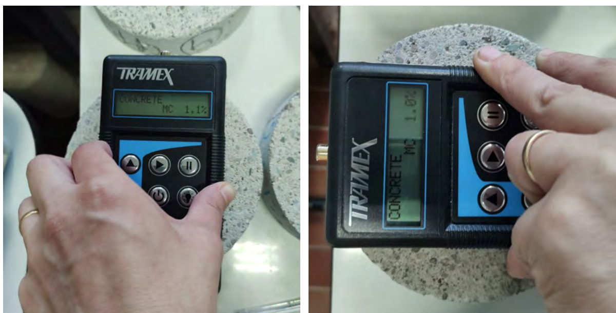
Figura 4.9. Mediciones de la humedad superficial para ensayo de permeabilidad al aire del Método Torrent
