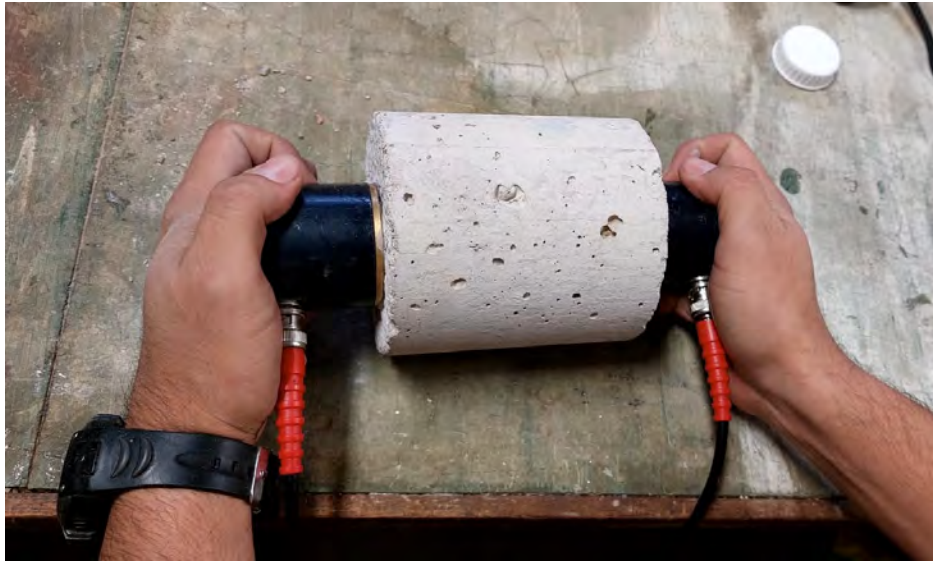
Figura 4.18. Medición del tiempo de traspaso del pulso ultrasónico
