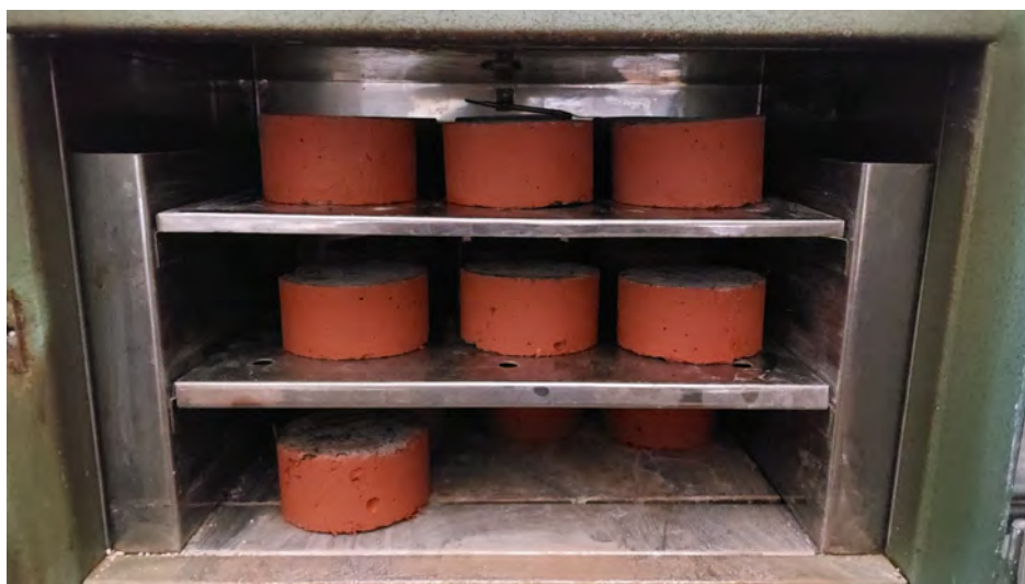
Figura 4.13. Secado de probetas para ensayo de succión capilar
