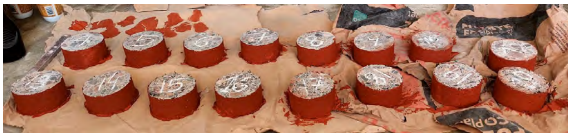
Figura 4.12. Sellado de probetas para ensayo de succión capilar
