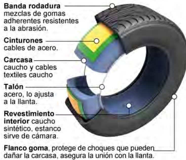
Figura 1.1. Esquema interno de un neumático. (Neumáticos KAMELGEN)
