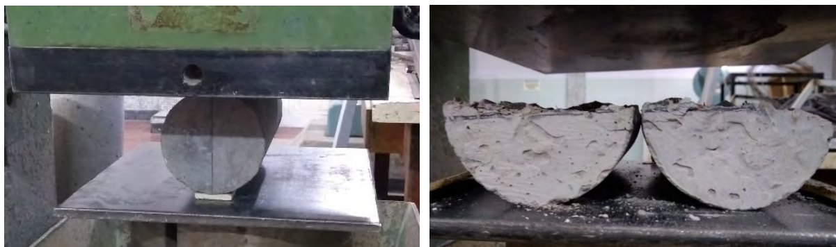
Figura 4.5. Probeta previo al ensayo de tracción por compresión diametral y luego de alcanzar la rotura
