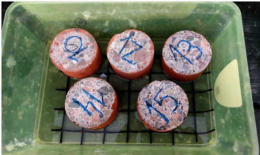
Figura 4.14. Instante ( t_0 ) en ensayo de succión capilar
