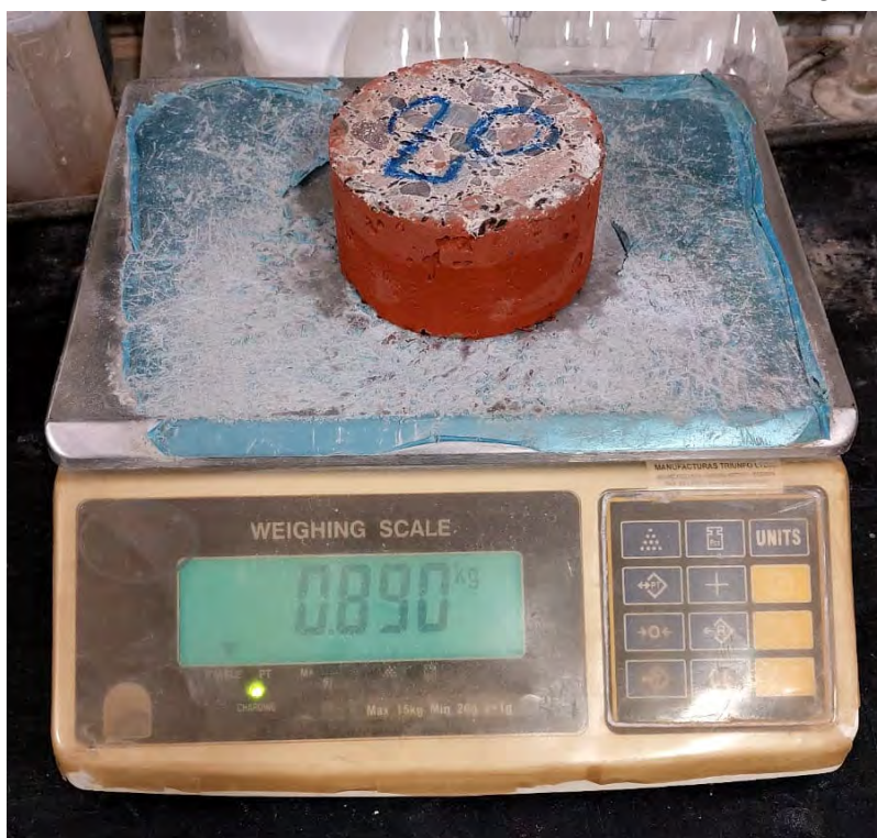
Figura 4.15. Proceso de pesaje de probetas para determinar la capacidad de succión capilar
