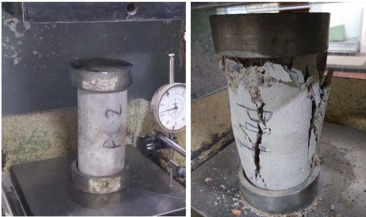
Figura 4.3. Probeta previo al ensayo de compresión axial y luego de alcanzar la rotura
