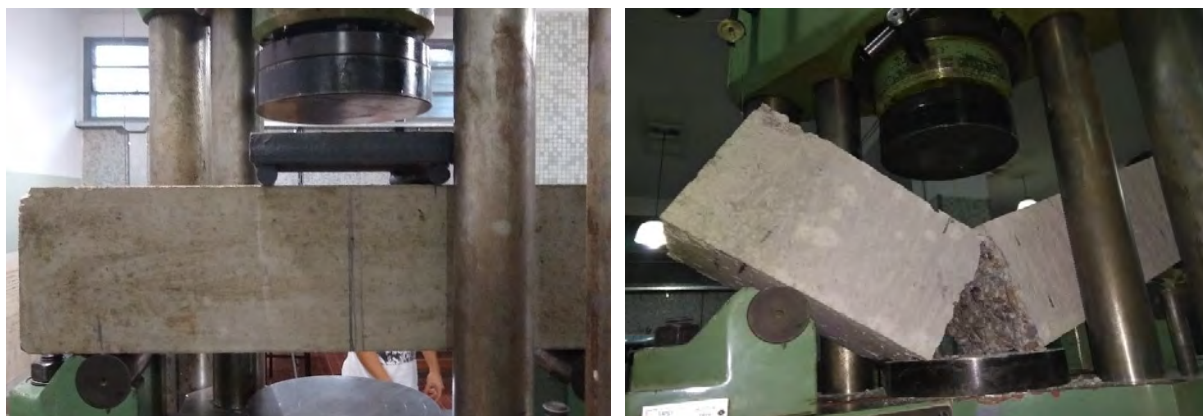
Figura 4.7. Probeta prismática previo al ensayo de tracción por flexión y luego de alcanzar la rotura
