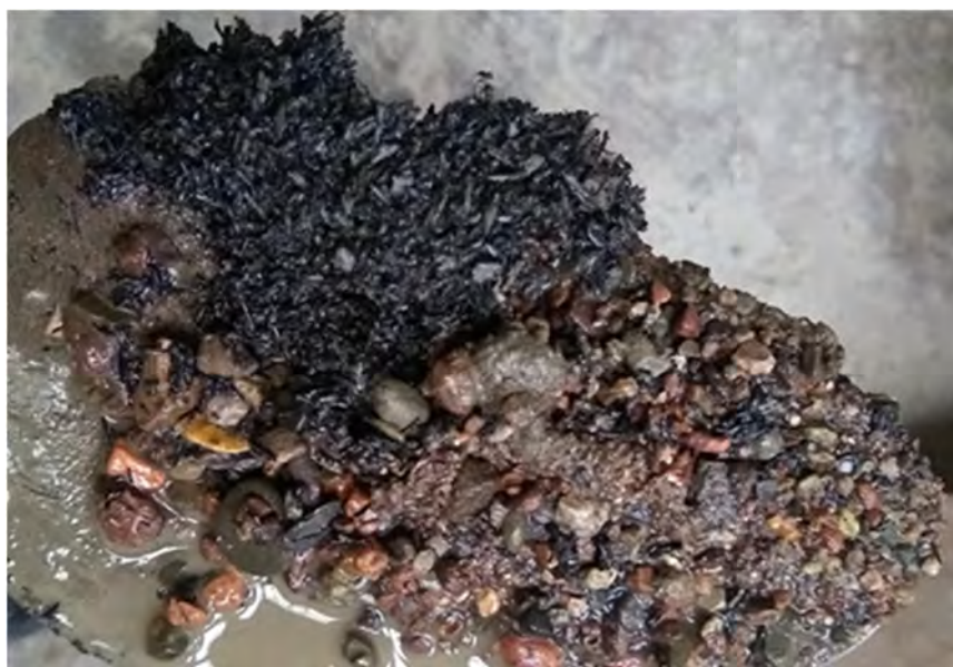
Figura 6.1. Material disgregado en la máquina hormigonera
