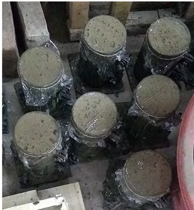
Figura 3.9. Moldeado de probetas cilíndricas de 100 mm x 200 mm
