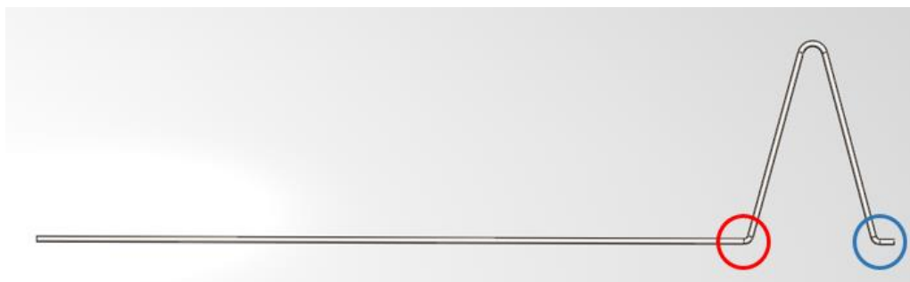
Figura 19. Vértices doblados producto de la sujeción de las mordazas.
