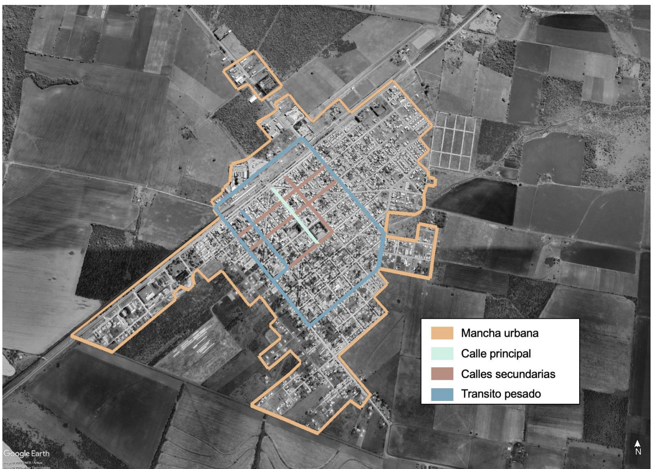
Figura N° 7 - Calles principales y desvíos para tránsito pesado.
