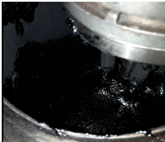
Figura 4.12. Dispersión de NFU en asfalto. (Fuente propia)
