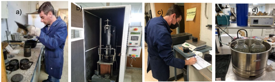
Figura 5.13. UPM. a) Llenado de moldes. b) Compactación Marshall. c) Determinación densidad Marshall. d) Determinación densidad máxima. (Fuente propia)
