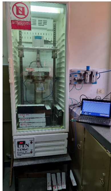
Figura 3.29. Equipo por cargas repetidas implementado. (Fuente propia)
