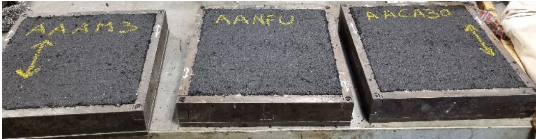
Figura 3.36. Capas intermedias de retardo de fisuras de tres tipos de mezclas estudiadas. (Fuente propia)
