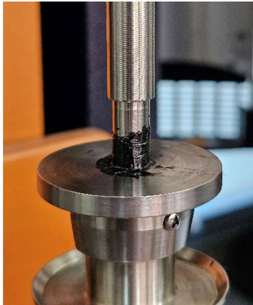
Figura 4.20. Geometría utilizada para prueba LAS. (Fuente propia)
