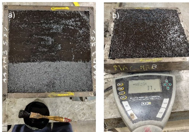
Figura 3.35. a) Aplicación de emulsión. b) Cantidad de emulsión colocada. (Fuente propia)
