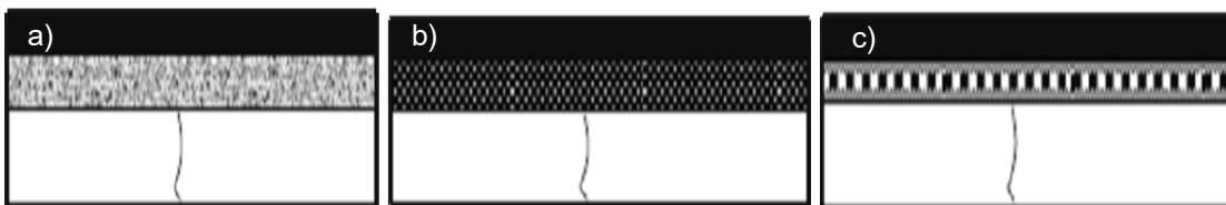
Figura 3.9. Esquema capas intermedias. a) base granular. b) capa. c) geosintético. (Rivera, 2021)
