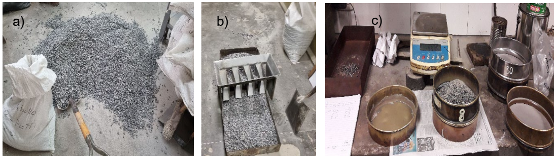
Figura 5.1. Ensayo de granulometría. a y b) Cuarteo. c) Tamizado. (Fuente propia)
