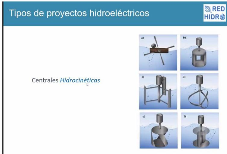
Figura 9. Tipos de Turbinas para río.
