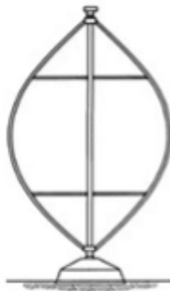
Estas turbinas usan la sustentación o empuje del fluido para funcionar. Tienen la ventaja de no necesitar orientarse, a diferencia de las turbinas de hélice, y no necesitan de un gran soporte, lo que hace que su mantenimiento y costo sean menores.
