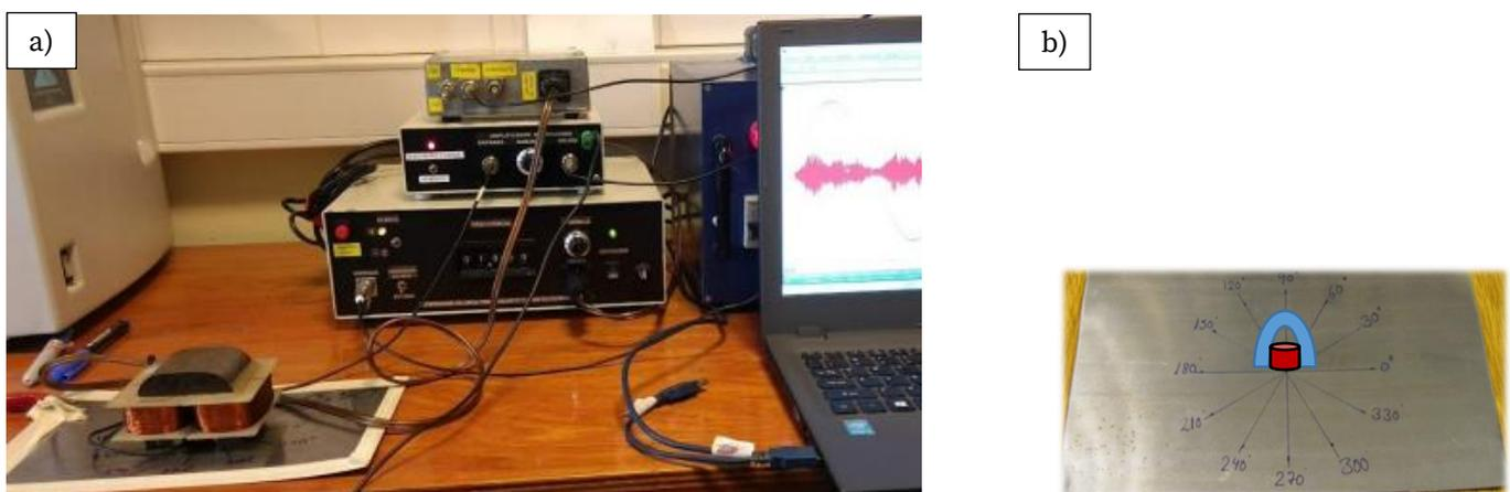
**Figura 2.** a) Fotografía del Sistema Experimental del RMB. b) detalle de la posición del yugo y la bobina sensora, ubicación 0°-180°.
