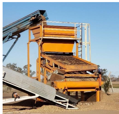
Zaranda vibratoria industrial (pre-limpieza de cáscara de maní)
