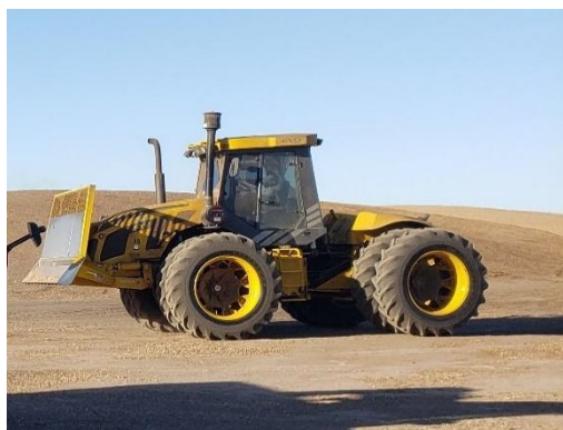
Tractor con hoja topadora frontal para acopio y compactación de cáscara de maní- Marca Pauny
