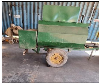
Figura N° 3.8.: Cisterna móvil para gasoil de 1500 litros.
