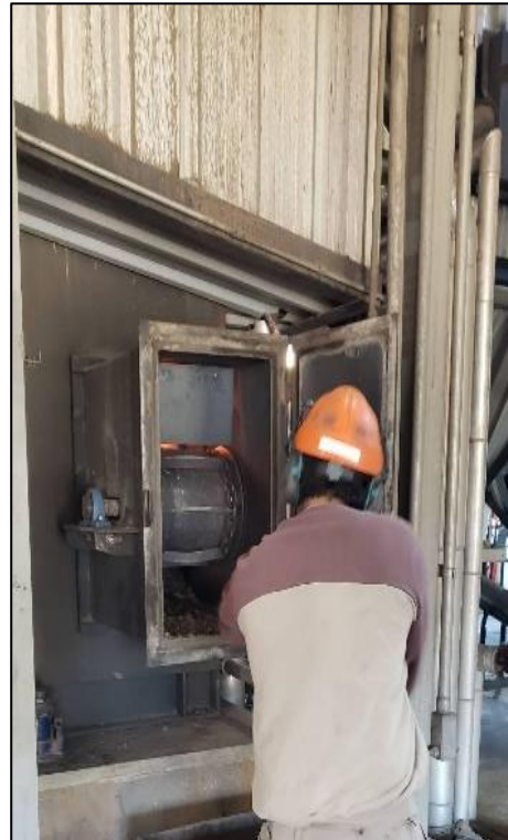
Figura N°2.9: Operario extrayendo cenizas finas.
