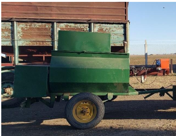
Cisterna de combustible sobre ruedas.
