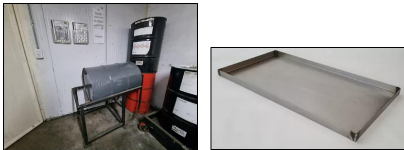
Figura N°3.13. Vista tambor sobre carro cuna volcador y bandeja metálica propuesta.
