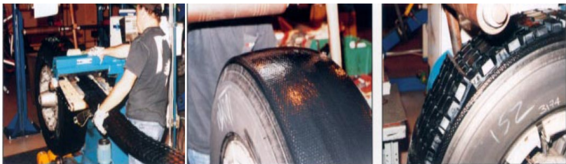
Figura 2.3. Etapas de recauchutaje de neumáticos. (En pocas palabras, 2006)
