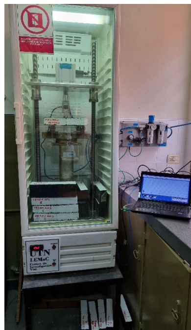
Figura 3.29. Equipo por cargas repetidas implementado. (Fuente propia)
