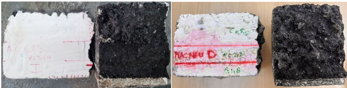
Figura 5.25. Vista probeta luego de rotura. a) Capa intermedia AA CA30. b) Capa intermedia MAC NFU. (Fuente propia)
