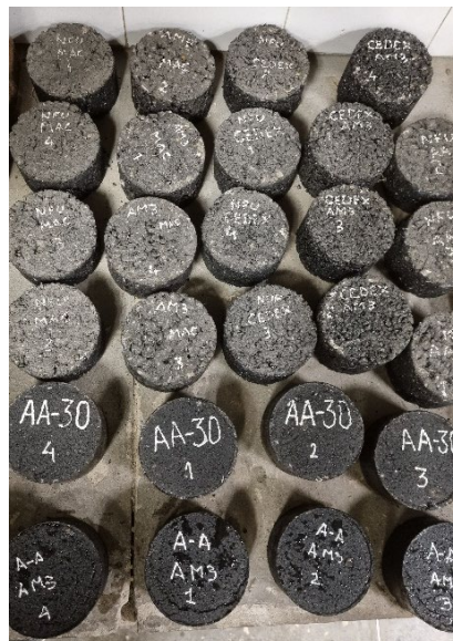
Figura 5.6. Probetas realizadas de las diferentes mezclas. (Fuente propia)
