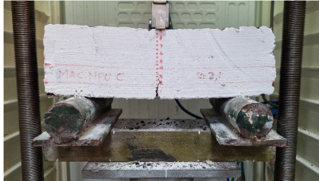
Figura 3.31. Apoyos y aplicación de la carga en viga. (Fuente propia)
