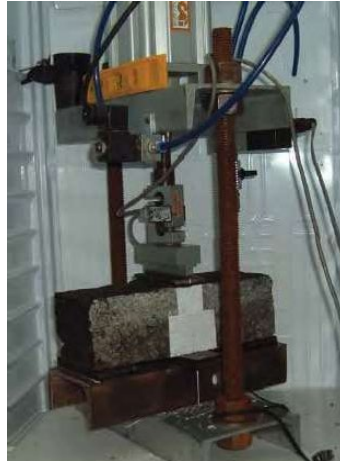
Figura 3.26. Equipo de carga cíclica IMAE. (Martínez et al., 2008; Delbono, 2014)
