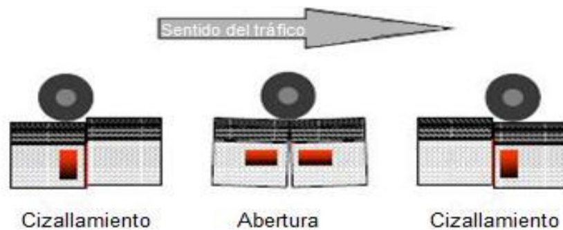
Figura 3.17. Solicitaciones experimentadas por la estructura del pavimento. (Molina, 2008)
