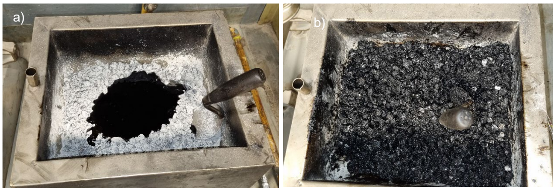
Figura 5.5. Elaboración de mezcla. a) Incorporación del ligante a los agregados. b) Proceso de mezclado. (Fuente propia)
