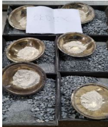
Figura 5.12. Preparación de agregados para probetas Marshall en UPM (Fuente propia)
