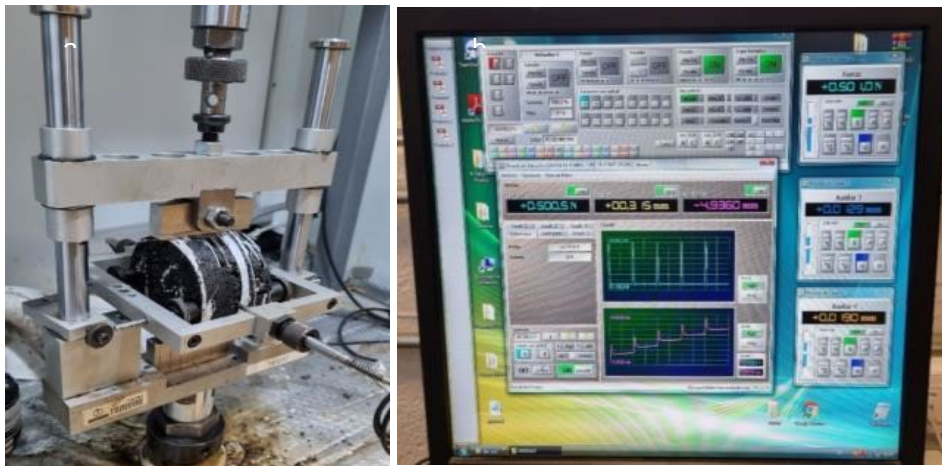
Figura 5.16. Ensayo módulo en UPM. a) Probeta en ensayo. b) Pantalla de software y resultados. (Fuente propia)
