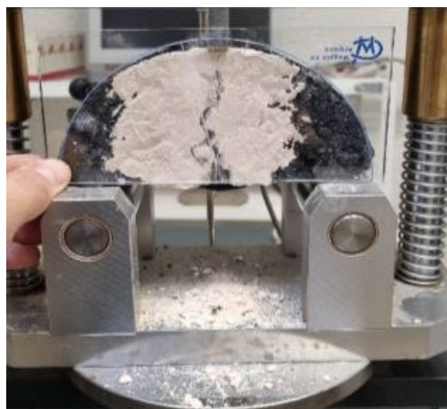
Figura 5.17. Ensayo propagación de la fisura mediante ensayo a flexión de una probeta
