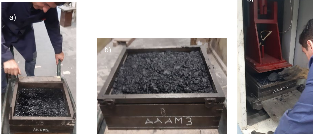
Figura 3.37. a) Colocación de sobre molde. b) Llenado de tercera capa. c) Compactación de última capa. (Fuente propia)
