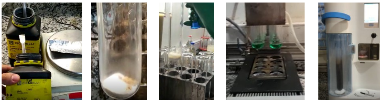
Figura 2: Preparación de muestra con catalizador, digestión, titulación y determinación de N 2 proteico.
