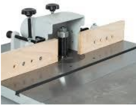
Figura 11. Referencia de protección de fresa.
