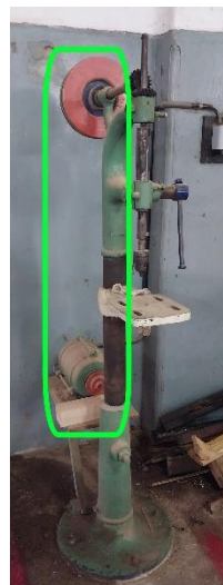
Figura 14. Referencia de resguardo móvil para motor.
