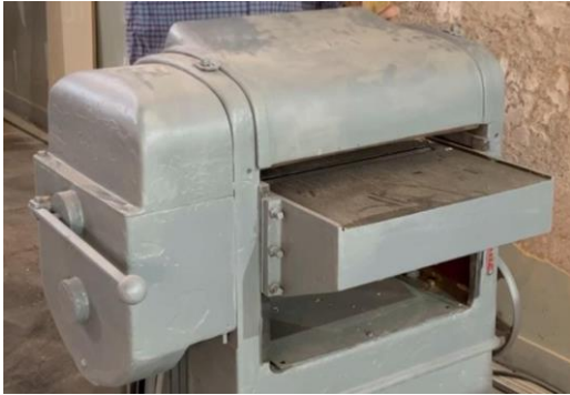
Figura 15. Resguardo que cubre todos los rodillos
