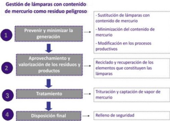
Fig. 36. Procedimiento del tratamiento final de lámparas con mercurio.
