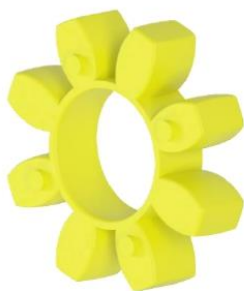
Estrella amarilla. Fabricada en poliuretano. Dureza: 92° Shore A.
