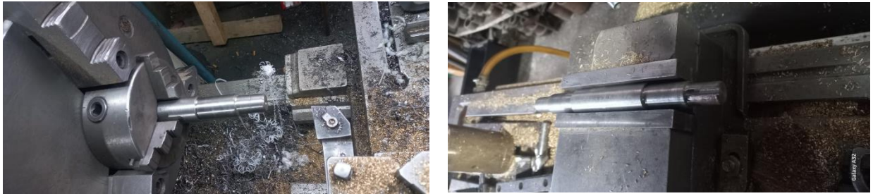
Img.49.1: Mecanizado de eje de transmisión
