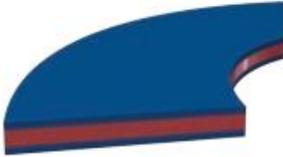
El material aislante es de espesor 3,0 mm y está recubierto en ambas caras por material sin asbesto de 1,5 mm. Puede ser Micarta CE, G10 u otros especiales. El material sellante es resistente a hidrocarburos.
