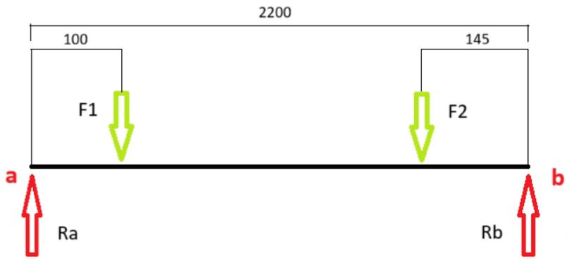
imagen 93: cargas y reacciones sobre perfiles laterales internos
