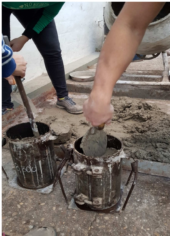
Imagen 24: Varillado y llenado de moldes
