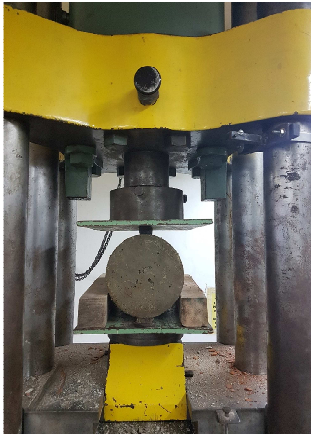
Imagen 32: Probeta colocada en la prensa para ser ensayada a tracción por compresión diametral
