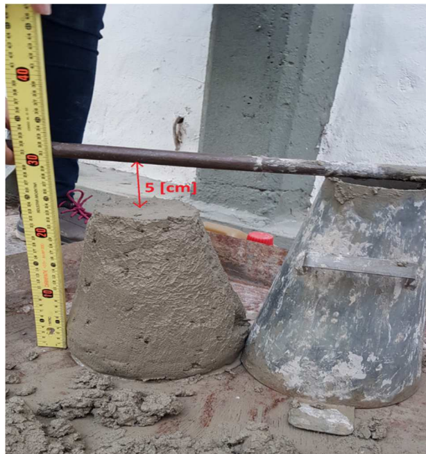
Imagen 23: Ensayo de asentamiento del cono de Abrams
