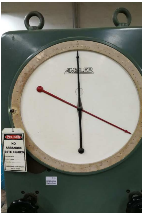
Imagen 28: Dinamómetro registrador de cargas
