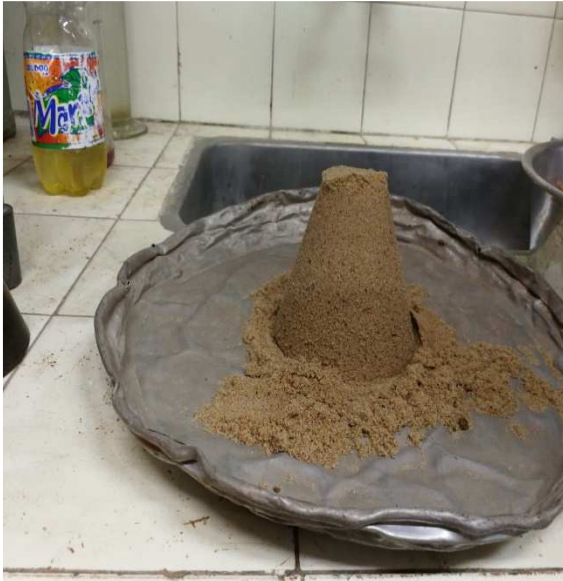
Imagen 6: Arena fina llevada a la condición de saturada superficie seca.
