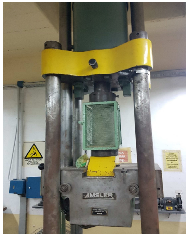
Imagen 29: Prensa AMSLER preparada para realizar el ensayo de compresión simple
