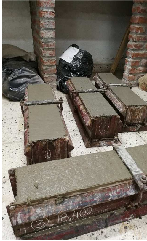
Imagen 26: Probetas prismáticas en estado fresco
