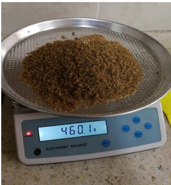
Imagen 18: Pesado de la arena gruesa para determinar posteriormente su humedad
