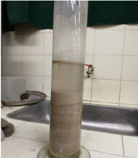
Imagen 14: Volumenómetro utilizado para determinar la densidad de la porción fina del material reciclado
