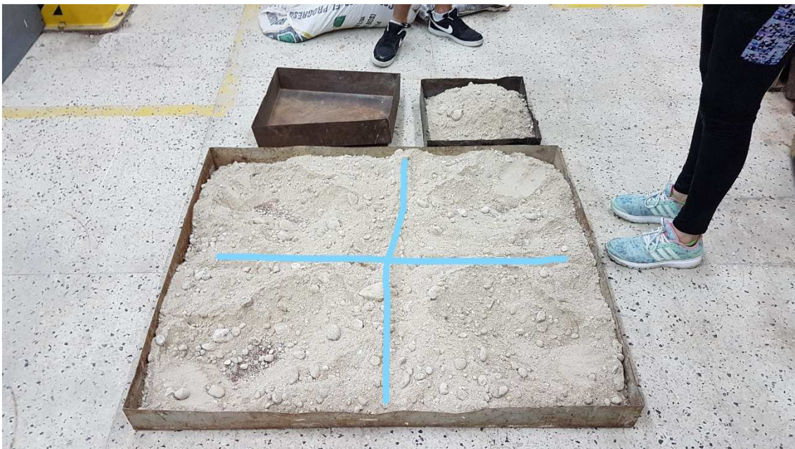
Imagen 13: Obtención de muestras mediante cuarteo.
