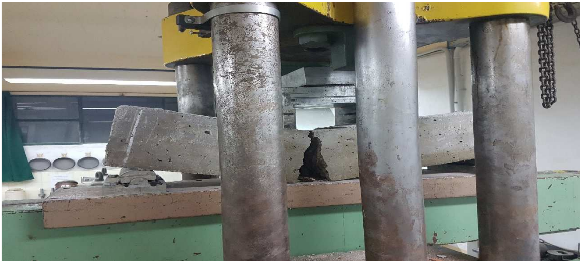
Imagen 36: Rotura de probeta por ensayo de flexión
