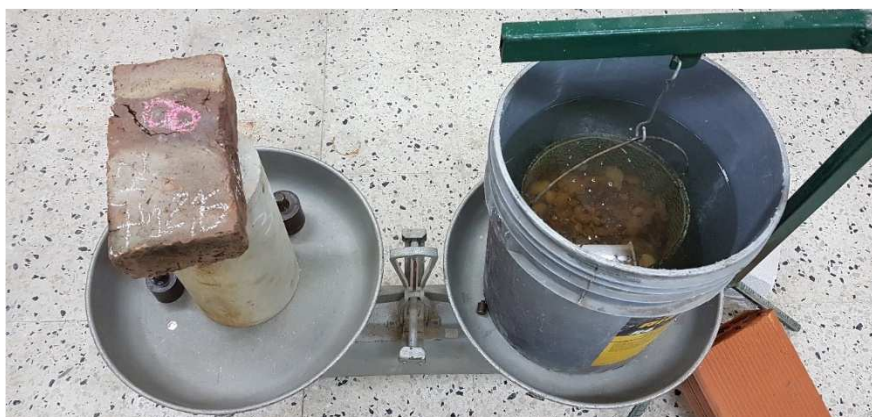
Imagen 3: Balanza hidrostática para determinar la densidad del canto rodado
