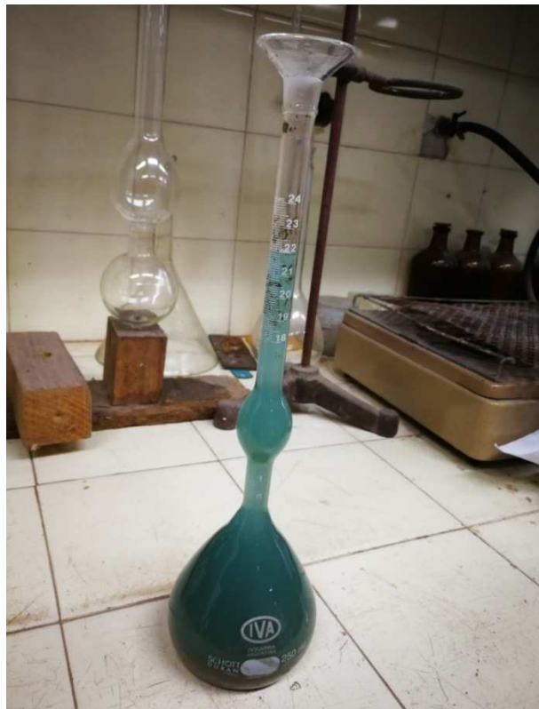
Imagen 17: Volumenómetro de Le Chatelier. Determinación del peso específico del cemento.
