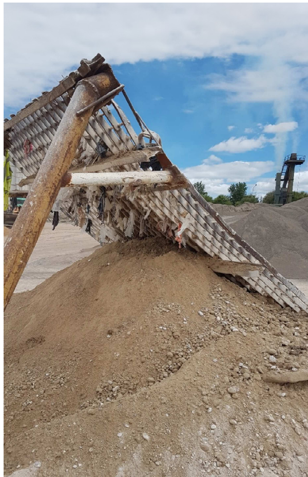
Imagen 11: Tamizado primario del material reciclado
