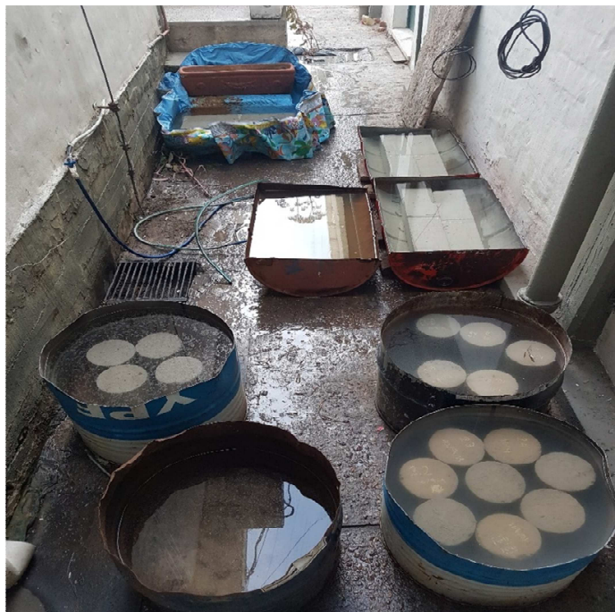
Imagen 27: Curado de probetas cilíndricas y prismáticas
