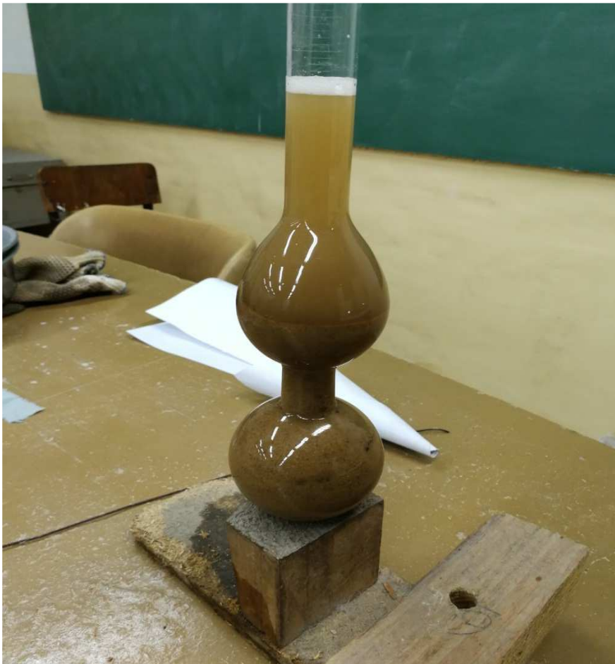
Imagen 8: Volumenómetro utilizado para determinar la densidad de la arena.
