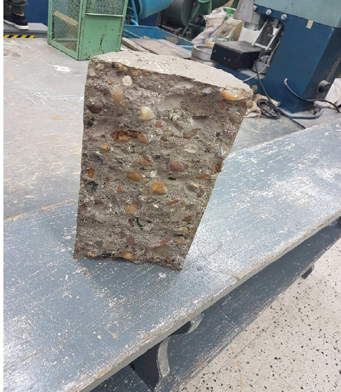
Imagen 33: Probeta luego de ser ensaya a tracción por compresión diametral
