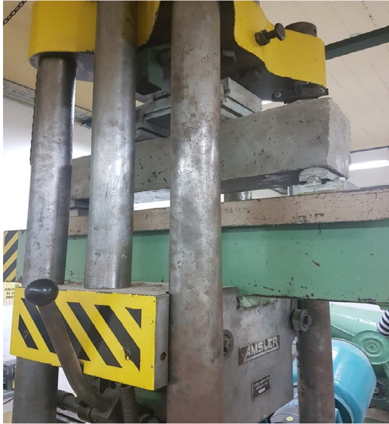
Imagen 35: Probeta prismática durante el ensayo de flexión
