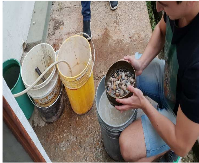
Imagen 15: Granulometría por vía húmeda del material reciclado
