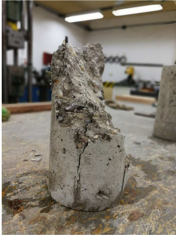
Imagen 30: Probeta luego de realizado el ensayo de compresión simple.
