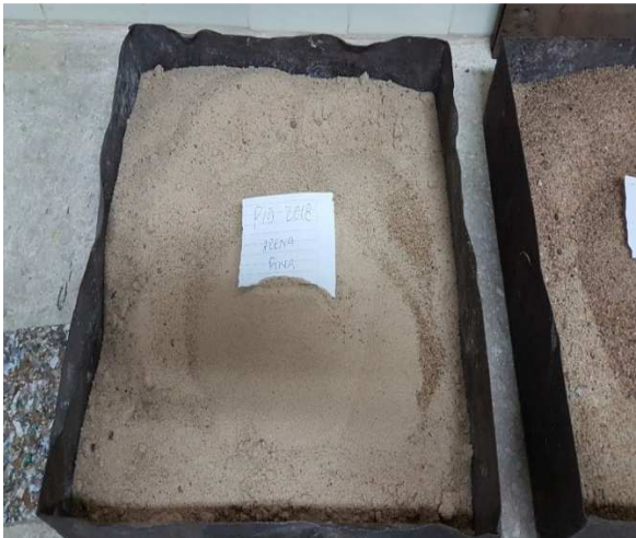
Imagen 4: Preparación de arena fina para ser posteriormente ensayada.
