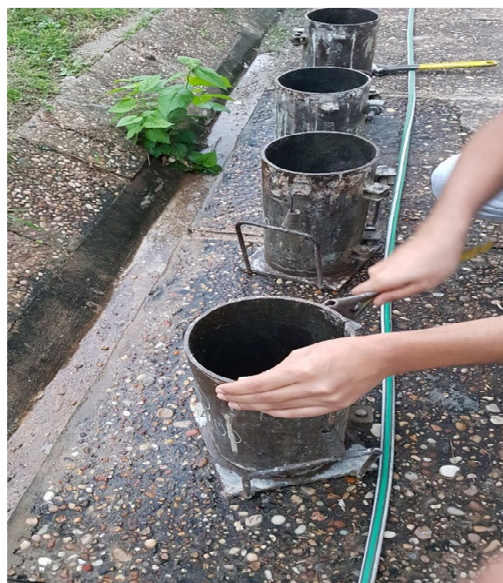
Imagen 22: Se ajustan los moldes de las probetas antes de llenarlas con el pastón de hormigón.
