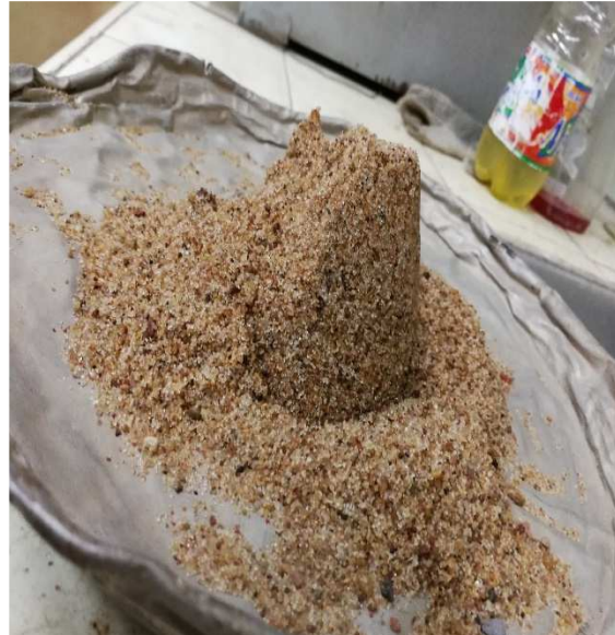
Imagen 7: Arena gruesa llevada a condición de saturado superficie seca.
