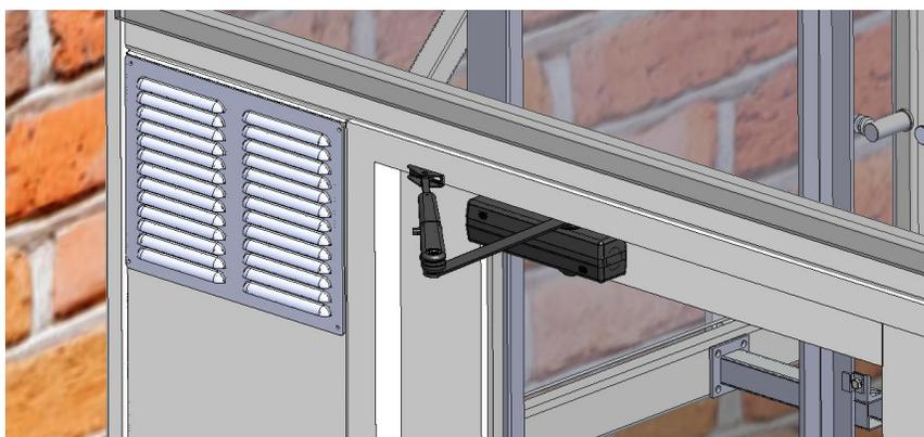
*Ilustración 131-Cierra Puertas Hidráulico*
