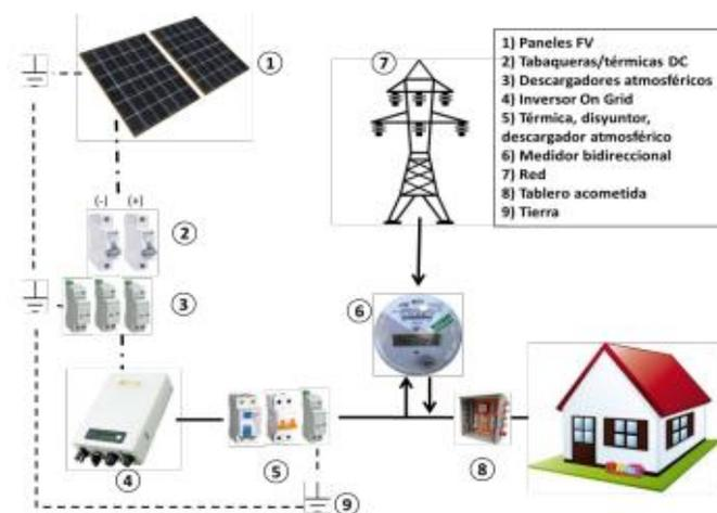
Ilustración 163-Instalación fotovoltaica ON GRID
