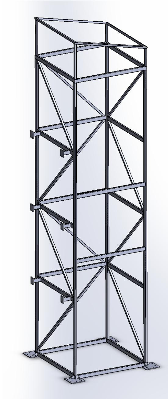
La carga total de 3500N se divide en cuatro puntos correspondientes a los puntos de apoyo de la base del conjunto motriz en la parte superior de la estructura (indicados por flechas de color rosa). Además, se toma en cuenta el peso propio de la estructura, representado por la flecha de color rojo.
