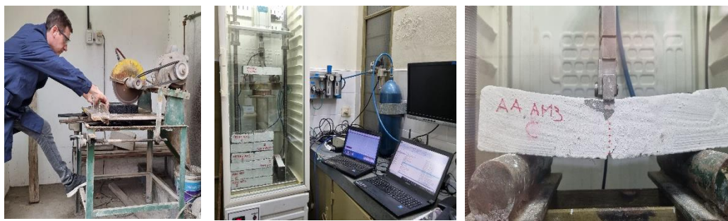
Figura 1: a) Corte de probetas. b) Equipo de módulo. c) Ensayo e inicio de fisura.
