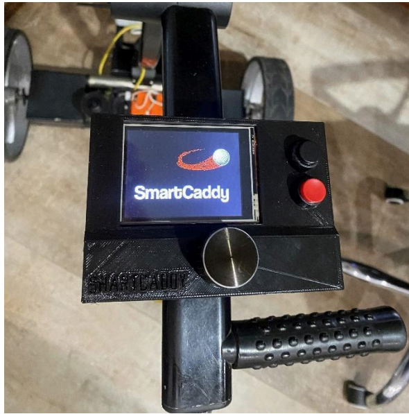
Figura 32: Montaje final pantalla encoder y botones. Fotografía de elaboración propia.
