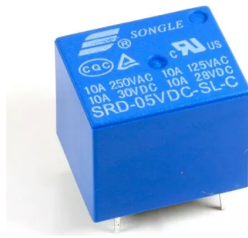
Figura 61: Relé de 10A. Fotografía de elaboración propia.
