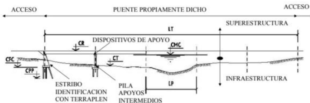
Fig.1: Elementos principales de un puente
