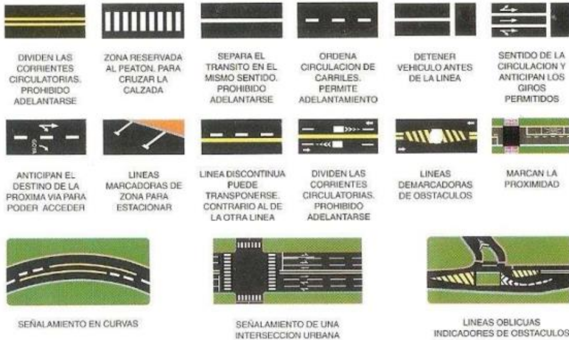
Imagen 79. Señalamiento Horizontal. Fuente: Pliego Único - DNV
