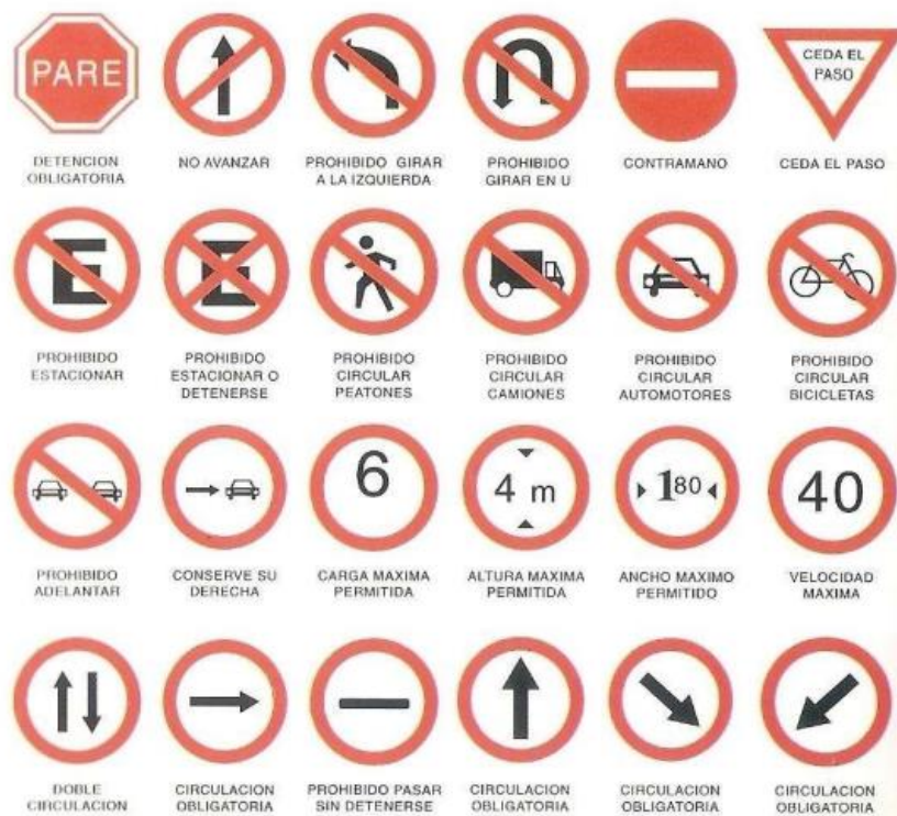
Imagen 4: Señalamiento vertical de reglamentación. Fuente: Pliego Único - DNV.
