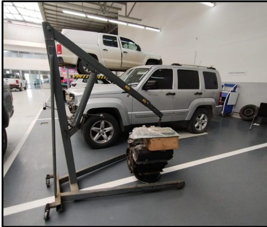
Anexo N°5: Pluma hidráulica/sopORTE.
