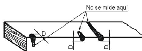
Figura 2: Medición de nudo de Arista
