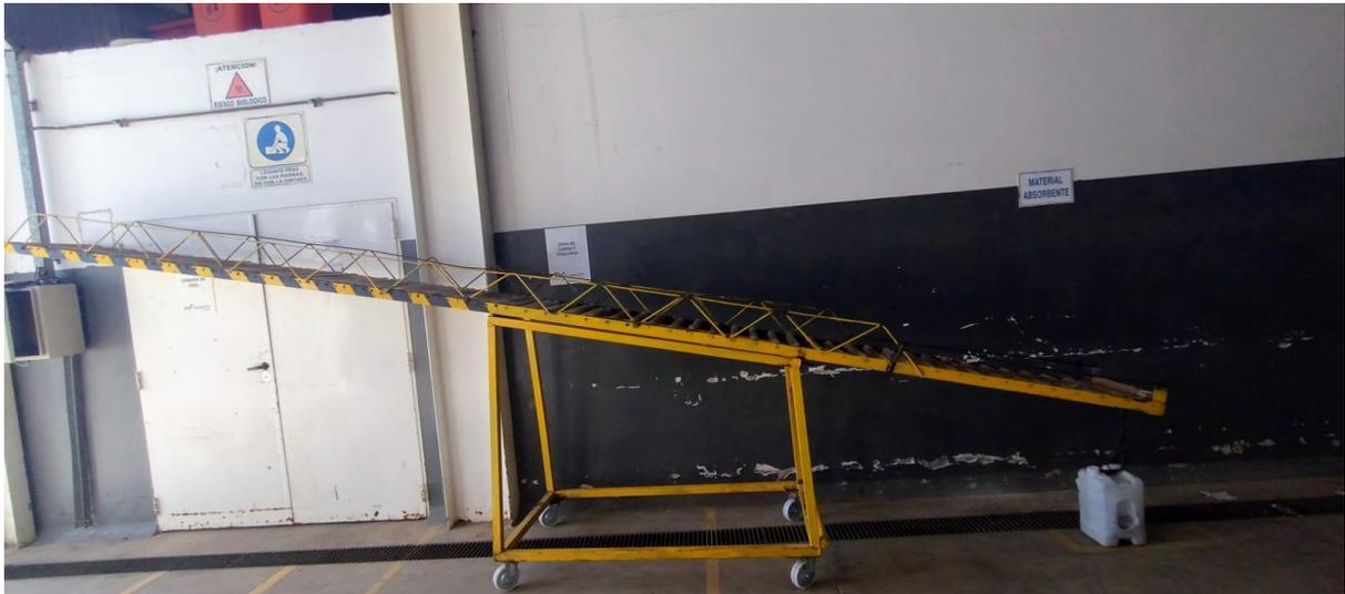
Transportador de rodillos por gravedad en la planta de tratamiento
