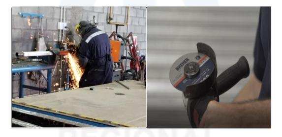
• Amoladora con disco de cepillo: Los cepillos de acero inoxidable son ideales para limpieza de acero inoxidable, aluminio, cobre y metales no ferrosos. Alambre de acero endurecido de calidad superior, separan los contaminantes de la superficie del material base sin desgastar ni modificar las dimensiones de la superficie en donde se va a soldar.
