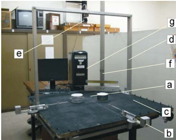
Figura 3. equipo para experiencias en 2D: a) discos; b) lanzadores; c) mesa de suspensión por aire; d) puente para suspensión de la cámara; e) cámara; f) péndulo para nivelación de la mesa; g) PC.
