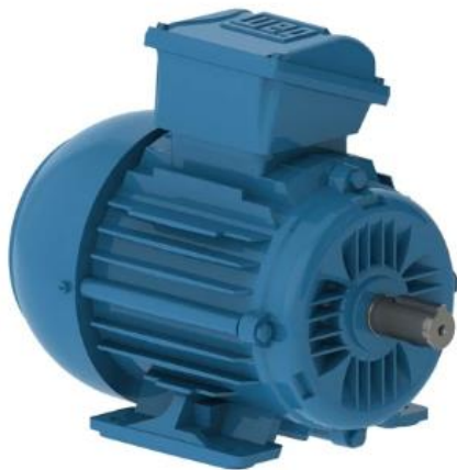
Imagen 7: motor seleccionado para el agitador. Fuente: W22 IE2 1.1 kW 4P 90S 3Ph 220-230-240/380-400-415//460 V 50 Hz IC411 - TEFC - B3T | W22 | Three Phase | Low Voltage IEC Motors | Electric Motors | WEG - Products.
