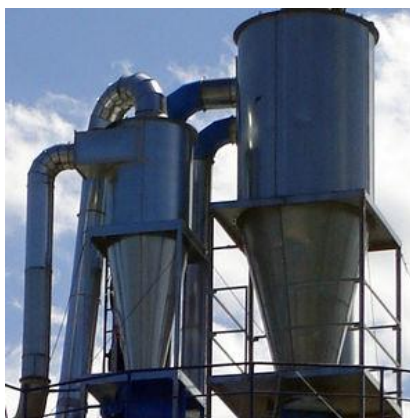
Imagen 1: Ilustración de un ciclón. Fuente: Operaciones unitarias en ingeniería química, 7ma edición.
