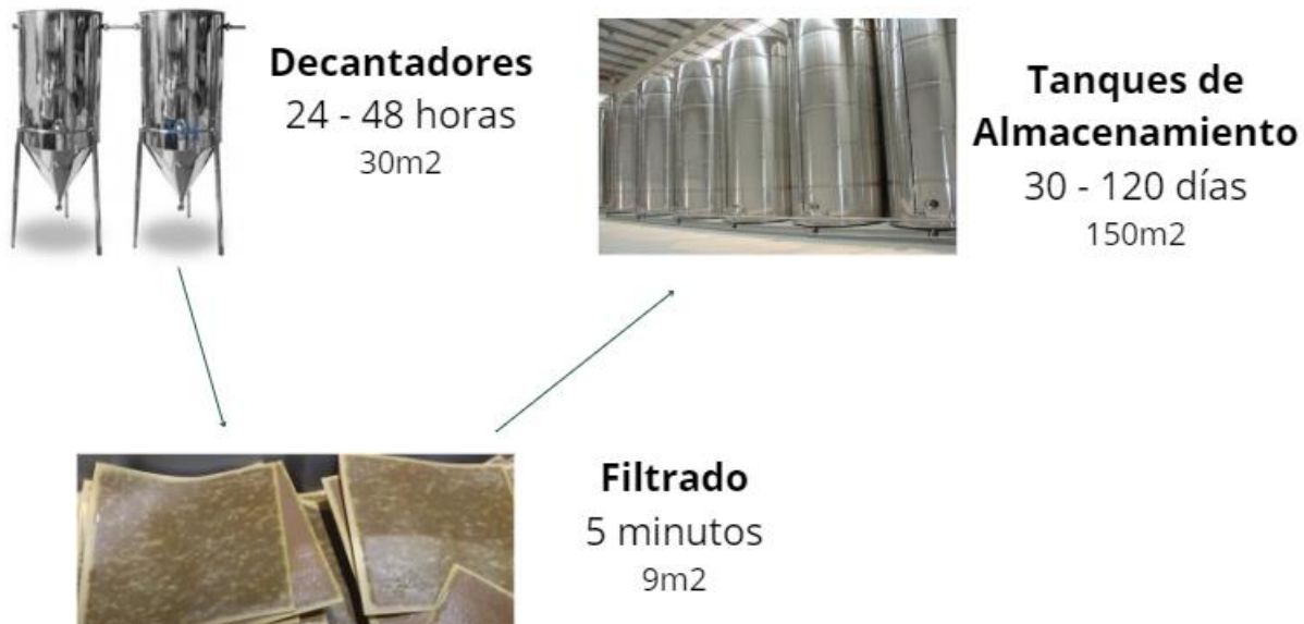
Ilustración 47 - Maquinaria a utilizar y tiempos de proceso II
