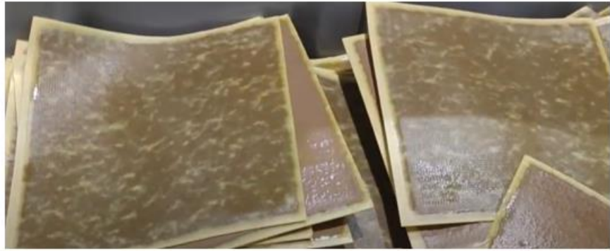
Ilustración 45 - Placa de celulosa sin filtrar (izquierda) y ya filtrada (derecha)
