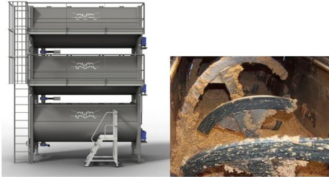
Ilustración 42 - Batidora - amasado
