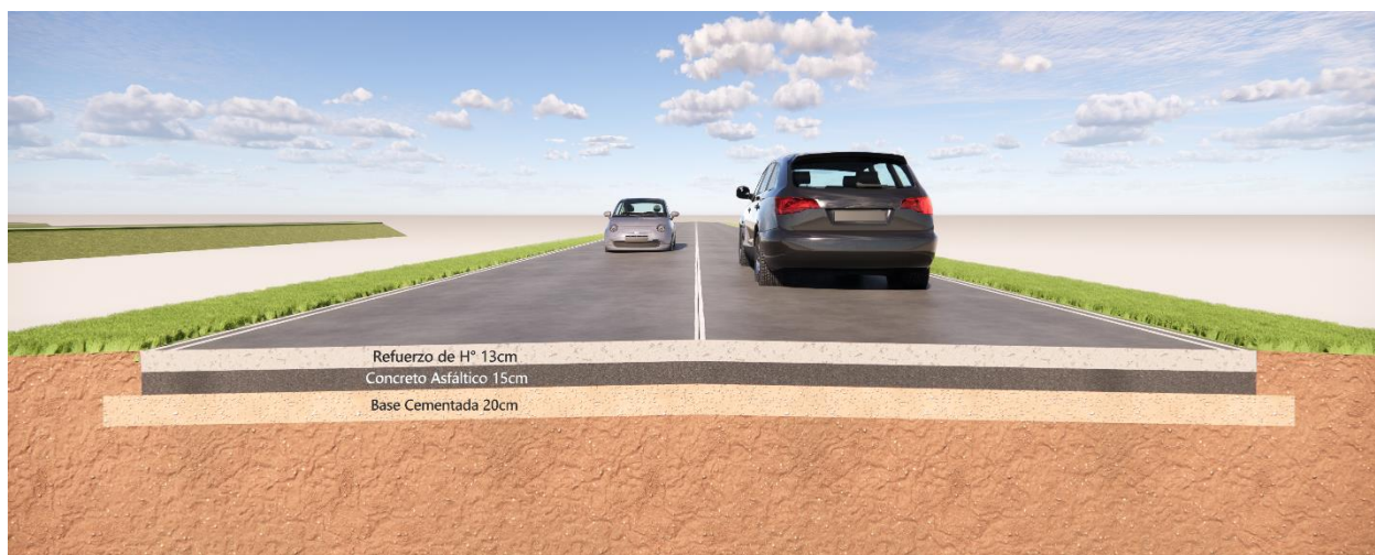
Figura 12. Paquete estructural propuesto en el Tramo 1.
