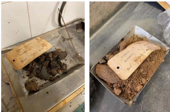
Figura 9. Determinación de peso de las muestras en laboratorio.
