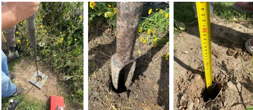
Figura 6. Ensayo DCP y extracción de muestras con barreno de mano.
