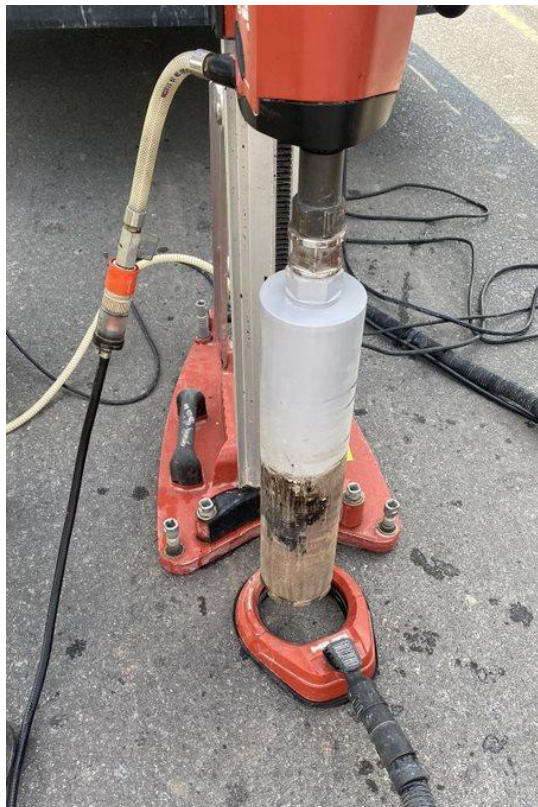
Figura 3. Equipo utilizado para la extracción de testigos.
