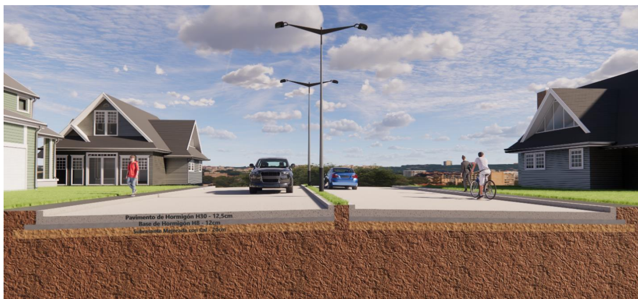
Figura 13. Paquete estructural propuesto en el Tramo 2.
