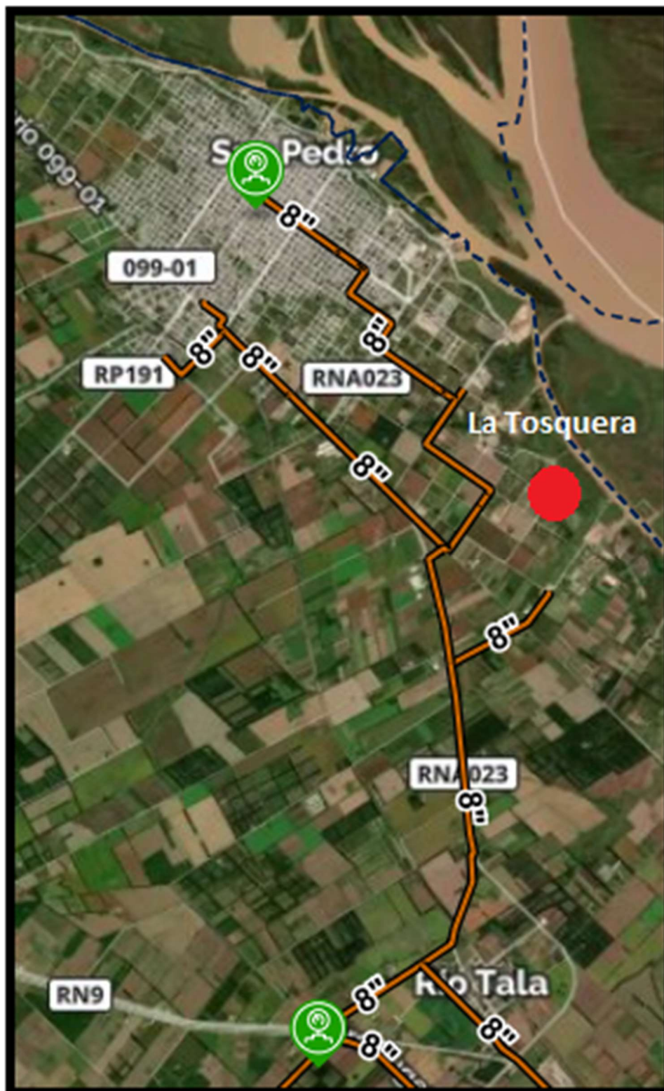
Imagen 31. Tendido de la red de Gas actual – Fuente: Elaboración propia, año 2021
