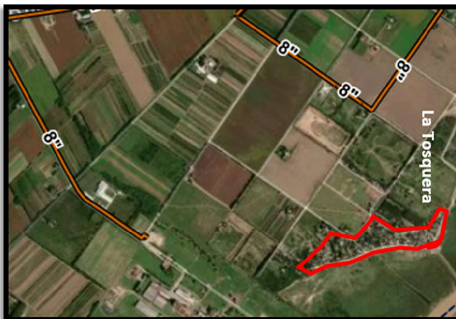
Imagen 32. Tendido de la red de Gas actual en la zona del barrio – Fuente: Elaboración propia, año 2021
