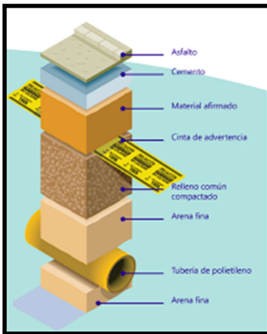
Imagen 151. Esquema típico del tendido de una red de gas- Fuente: ENARGAS, 2016
