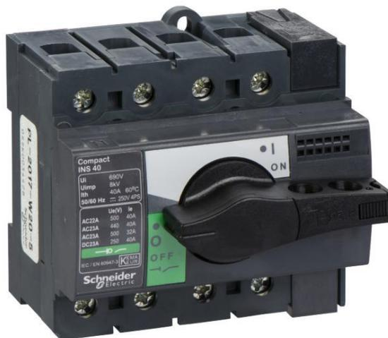
**Descripción:** Los interruptores seccionadores conectan y desconectan líneas, principalmente para desenergizar y aislar una parte de la red antes de repararla.
