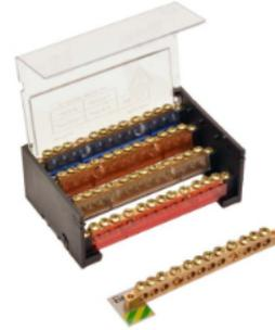
**Modelo:** 4 12 125AP // Puntos de Conexión: 12 // Las barras están semi cubiertas con vainas de policarbonato de acuerdo a las normas IRAM 2183, además posee una barra colectora de puesta a tierra y chapa identificadora.
