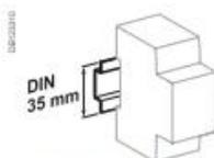
Se coloca a presión en rieles DIN de 35 mm.
