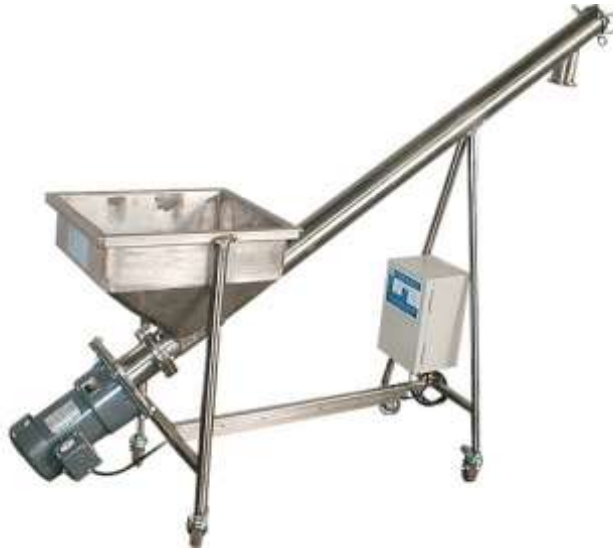
Figura 10.27. Tornillo sin fin para transporte de grano pelado modelo LS100 Fuente: www.etwinternational.com.ar
