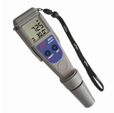
*Figura 8. Equipo utilizado para determinar la temperatura y pH del agua durante el experimento de crecimiento de albahaca.*
