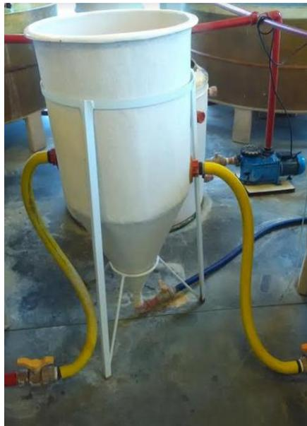
**Figura 5.** Filtro sedimentador de RSS.
